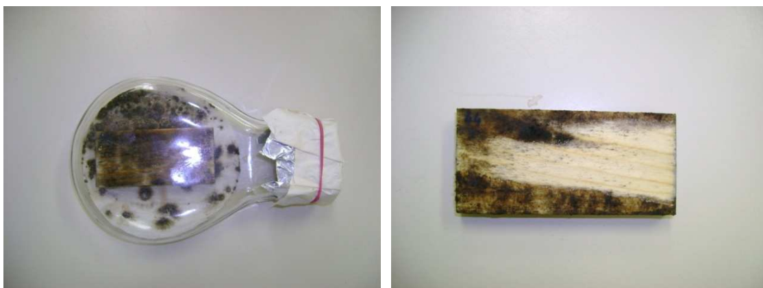
Slika 17: Vzorec izpostavljen sporam v Kollejevi steklenici (levo). Neočiščen vzorec hif po izpostavljenem šesttedenskem času v rastni komori (desno)
