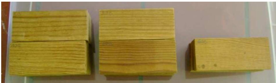
Slika 23: Kemično modificirani vzorci bora pri temperaturi modifikacije 150 °C. Meldur 5 % (zgoraj levo), Meldur 5 % z dodatkom 4 % katalizatorja H_3BO_3 (spodaj levo). Meldur 10 % (zgoraj sredina), Meldur 10 % z dodatkom 4 % katalizatorja H_3BO_3 (spodaj sredina). Termično modificirani vzorci bora pri temperaturi modifikacije 150 °C (desno)
