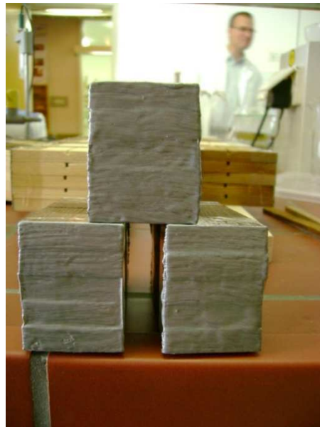
Slika 11: Zaščitena čela vzorcev smreke z EPOLOR premaznim sredstvom
