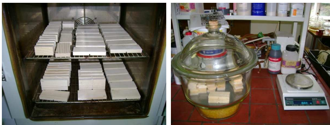
Slika 6: Laboratorijski sušilnik (levo). Eksikator in laboratorijska tehtnica (desno)
