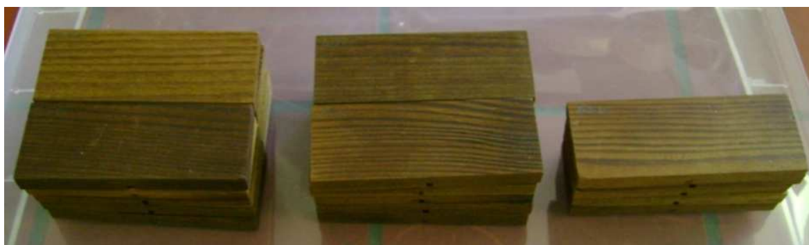
Slika 24: Kemično modificirani vzorci bora pri temperaturi modifikacije 170 °C. Meldur 5 % (zgoraj levo), Meldur 5 % z dodatkom 4 % katalizatorja H_3BO_3 (spodaj levo). Meldur 10 % (zgoraj sredina), Meldur 10 % z dodatkom 4 % katalizatorja H_3BO_3 (spodaj sredina). Termično modificirani vzorci bora pri temperaturi modifikacije 170 °C (desno)
