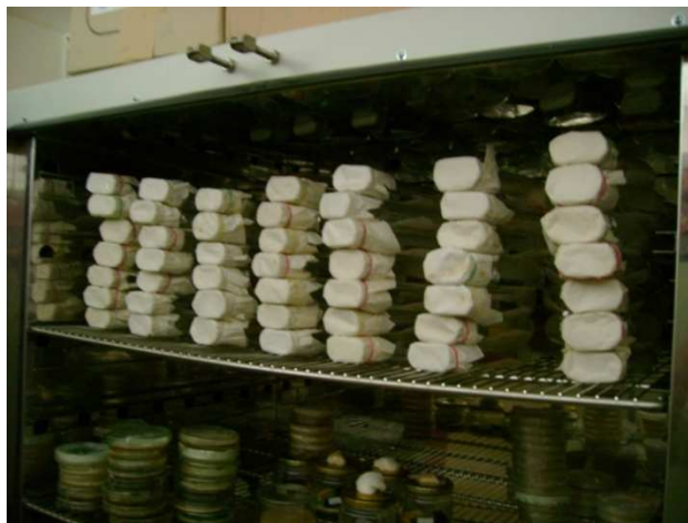
Slika 16: Zložaj Kollejevih steklenic z vzorci v rastni komori (zgoraj)
