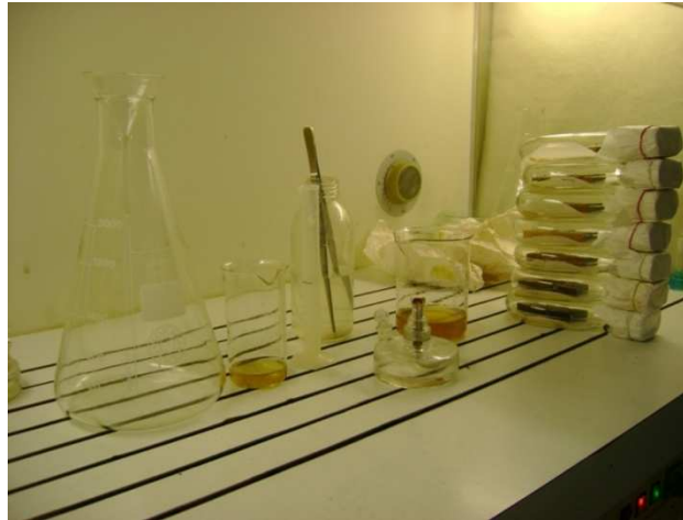
Slika 15: Laminarij s potrebnim priborom za okužbo vzorcev. Kollejeve steklenice z vsebnostjo 15 mL suspenzije gliv modrivk in z vstavljenim vzorcem
