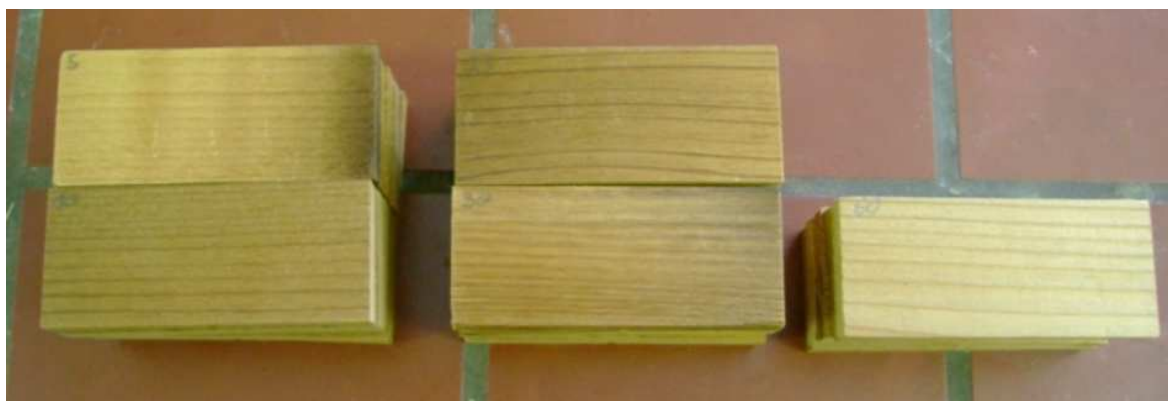
Slika 25: Kemično modificirani vzorci smreke pri temperaturi modifikacije 150 °C. Meldur 5 % (zgoraj levo), Meldur 5 % z dodatkom 4 % katalizatorja H_3BO_3 (spodaj levo). Meldur 10 % (zgoraj sredina), Meldur 10 % z dodatkom 4 % katalizatorja H_3BO_3 (spodaj sredina). Termično modificirani vzorci smreke pri temperaturi modifikacije 150 °C (desno)
