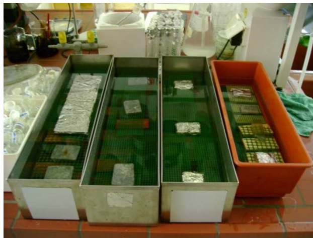
Slika 10: Izpiranje modificiranih vzorcev smreke in bora
