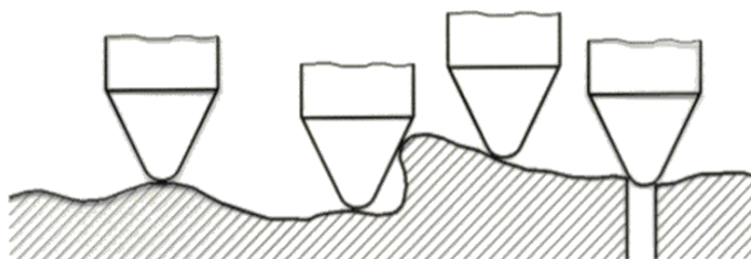
Slika 37: Igla sledi le nepopolni obliki površine
