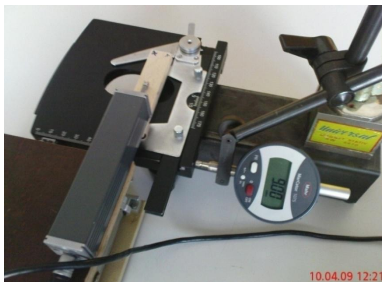
Slika 40: Priprava za nastavljanje pozicije meritve hrapavosti površine
