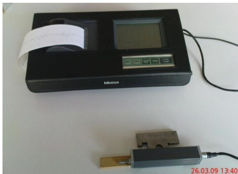
Slika 39: Naprava Mitutoyo SJ-301 za merjenje hrapavosti površine
