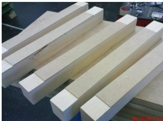
Slika 47: Prikaz že porezanih vzorcev za merjenje gostotnega profila
