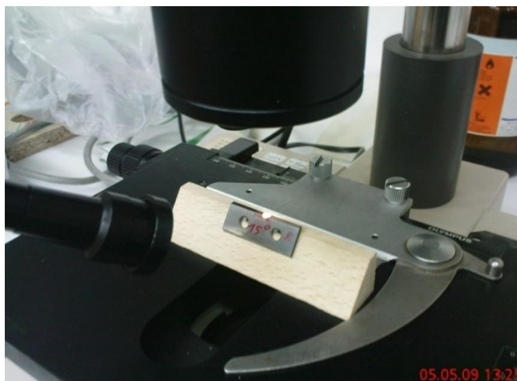
Slika 43: Priprava za opazovanje proste ploskve noža
