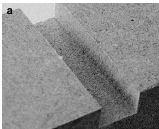
Slika 10: Prikaz rezkane površine s parametri podajanja 0,5 m/min (Davim in sod., 2007)
