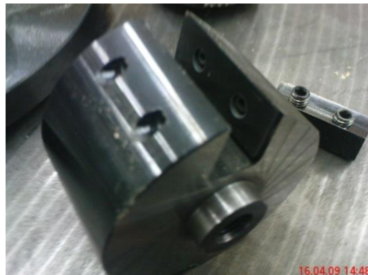
Slika 29: Vpenjalna glava – pogled na vpenjalni sistem z zagozdo
