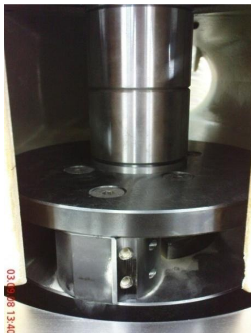
Slika 32: Eksperimentalno orodje, vpeto na glavno vreteno
