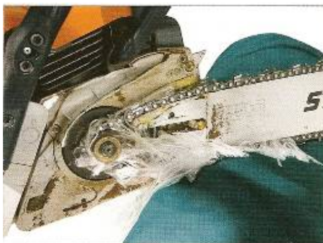
Slika 9: Navita vlakna na območju pogonskega zobnika (Katalog Stihl, 2008: 198)
