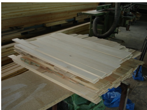
Slika 35: Izdelava lamel dimenzij 550 x 50 x 4 mm za lepljenje
