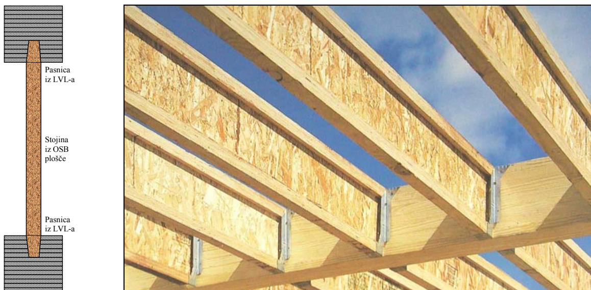
Slika 14: Sestava I-nosilca iz LVL-a in OSB plošče (levo) ter prikaz uporabe pri gradnji stropa (desno)
