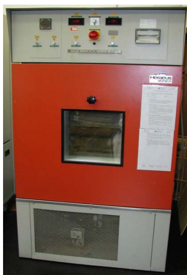
Slika 36: Klima komora za kondicioniranje lesa v normalnih pogojih ( T = 20\text{ }^{\circ}\text{C} , \text{RZV} = 65\% )
