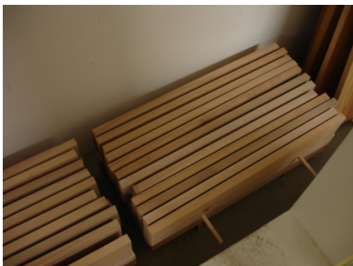
Slika 34: Prikaz klimatiziranja lesa v komori ( T = 22^{\circ}\text{C} , RZV = 55 – 65 %) pred razžagovanjem na lamele
