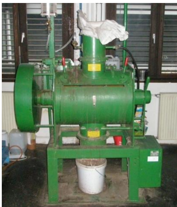
Slika 12: Laboratorijski mešalnik za oblepljanje iverja Lodige LT 64 – FM 130 D12F
