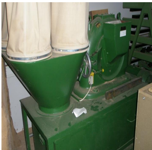
Slika 7: Laboratorijski iverilnik za iverjenje (pomlevanje) Condux LT 61 – CSK/N1
