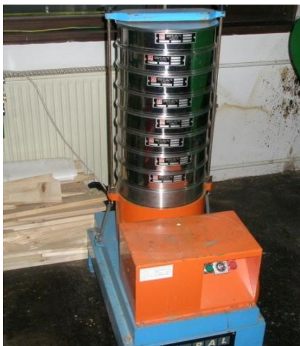
Slika 10: Laboratorijski stresalnik (sejalnik) za izvedbo sejalne analize Pal LT 62
