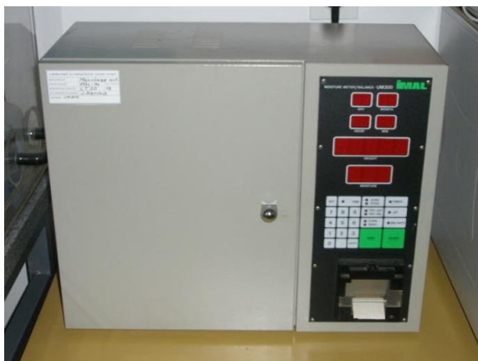
Slika 9: Laboratorijski merilnik za merjenje vlažnosti iverja Imal – Mo LT 50 – U 200
