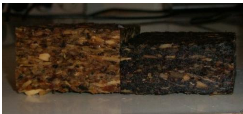
Slika 28: Debelinski nabrek po 24-urnem namakanju preizkušancev v vodi brez vsebnosti iverja skorje (levo) in preizkušane s 50 % deleža skorje (desno)
