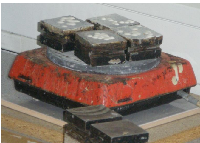
Slika 24: Taljenje lepila na prijemalu za ugotavljanje razslojne trdnosti ivernih plošč
