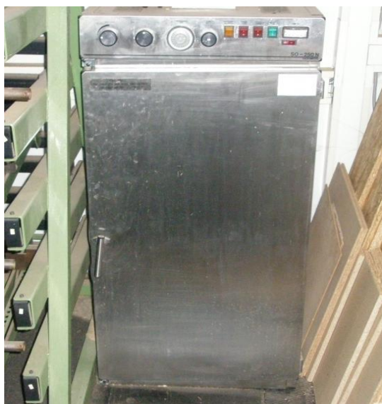
Slika 8: Laboratorijski sušilnik za sušenje iverja Elektromed LT 59
