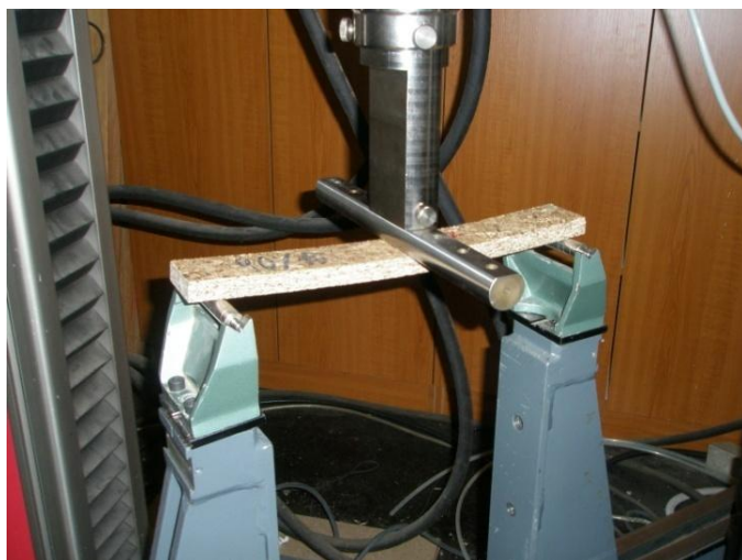
Slika 23: Prikaz ugotavljanja upogibne trdnosti
