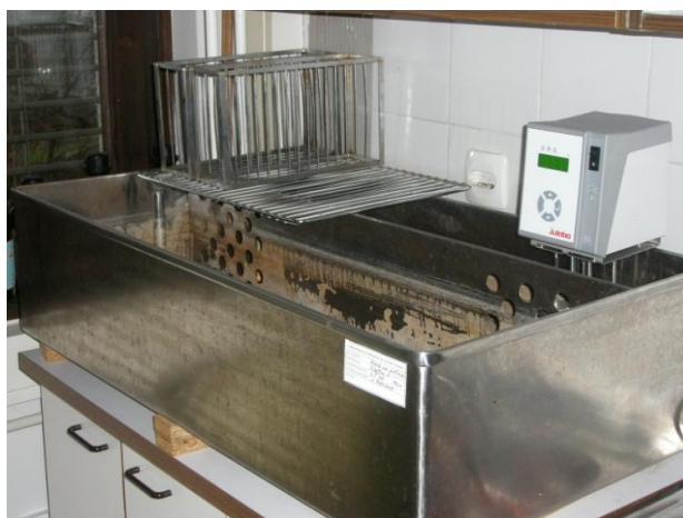
Slika 20: Vodna kopel za namakanje preizkušancev v vodi (določevanje debelinskega nabreka)
