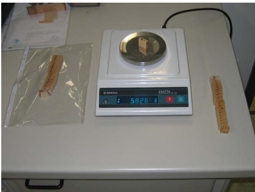
Slika 6 Tehtanje vzorcev za določitev radialnega vlažnostnega profila (foto Aleš Straže).
