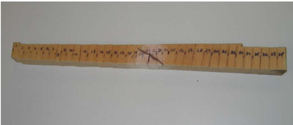
Slika 5 Vzorci za določitev radialnega vlažnostnega profila (foto Aleš Straže).
