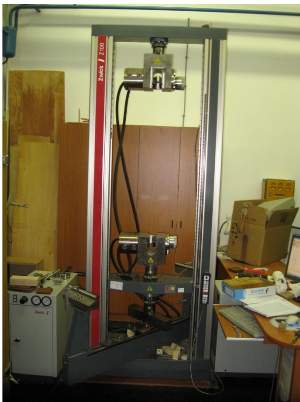
Slika 8: Univerzalna naprava za mehansko testiranje ZWICK Z100
