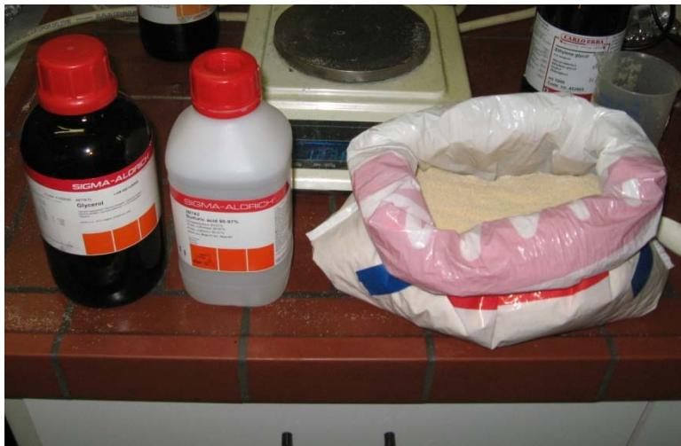
Slika 1: Reaktanti za pripravo utekočinjenega lesa: les, glicerol in žveplova(VI) kislina
