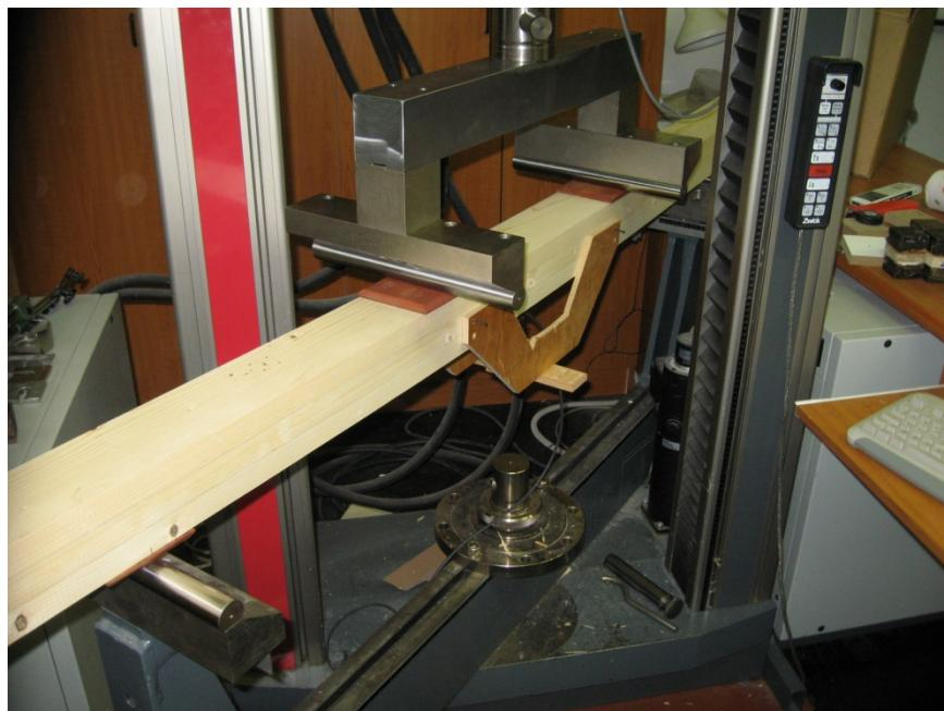
Slika 12: Univerzalna naprava za mehansko testiranje ZWICK Z100 (preizkus po SIST EN 408)
