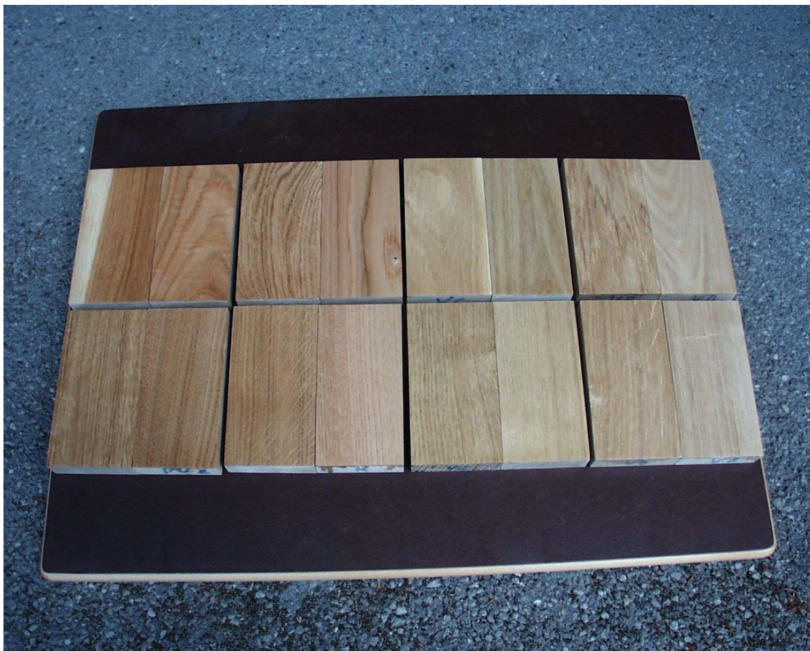
Slika 32: Barvne razlike (levo hrast, desno kostanj) med različnimi vrstami premazov. Od leve proti desni sledijo poliuretanski lak, lak s kislinskim utrjevalcem, vodni lak C in vodni lak B.
