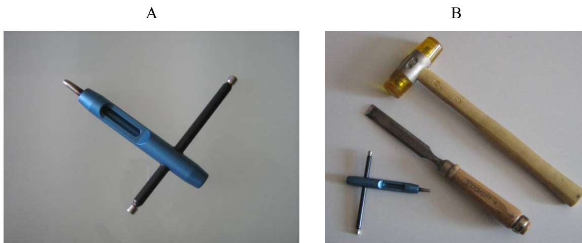
Slika 10: A – Specialno orodje za odvzem mikro vzorcev Trephor; B – Dleto in kladivo, ki ju poleg Trephorja potrebujemo, za odvzem mikro vzorcev.
