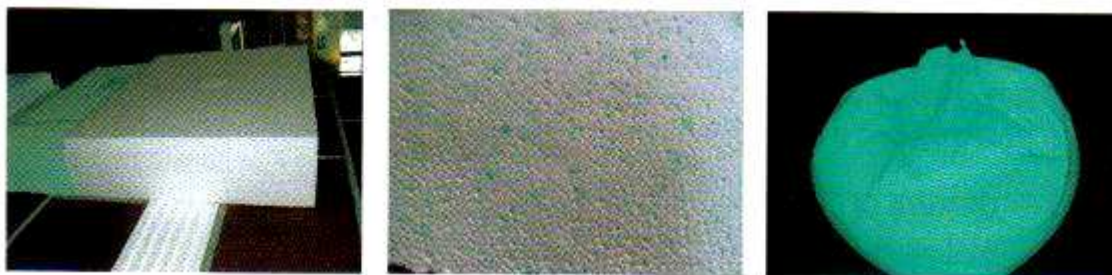
Slika 26: Termoizolacijska plošča iz ekspandiranega polistirena (levo), zgradba plošče iz ekspandiranega polistirena (na sredini), pohištveni element, napolnjen s polistirenskimi kroglicami (desno) (Petrič, 2008)
