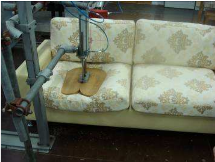
Slika 40: Statična obremenitev sedala
