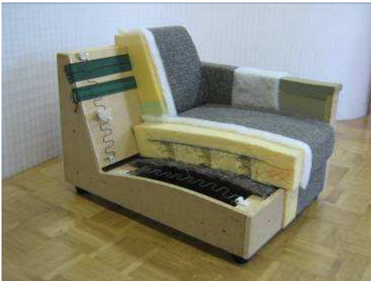
Slika 18: Prerez klasičnega oblazinjenega pohištva
