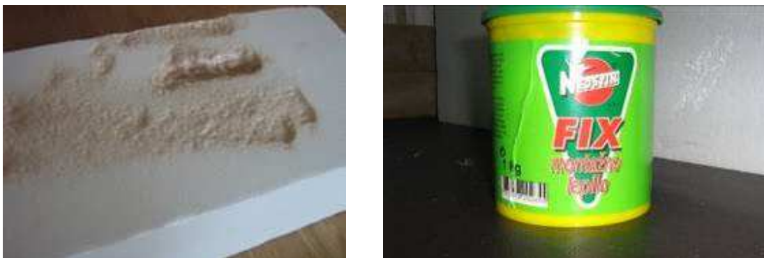
Slika 33: Topljenje ekspandiranega polistirena na sliki levo in izbrano lepilo Neostik DS 111 FIX na desni strani
