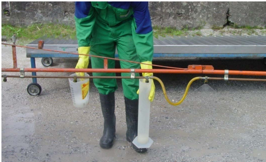
Slika 14: Merjenje pretoka posamezne šobe (foto: V. Škedelj)
