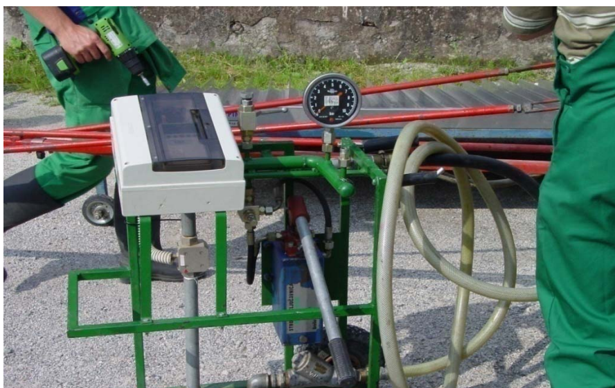
Slika 17: Naprava za preizkus točnosti manometra (foto: V. Škedelj)
