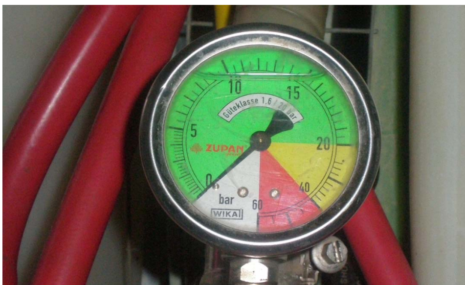
Slika 8: Glicerinski manometer za pršilnike (foto: V. Škedelj)
