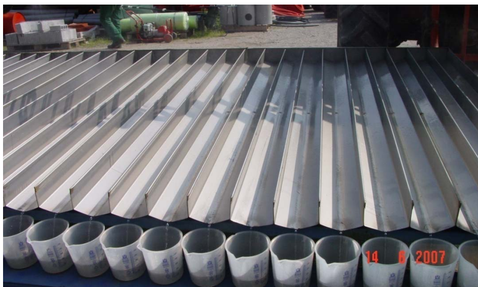
Slika 15: Miza za testiranje z žlebovi in merilnimi valji (foto: V. Škedelj)
