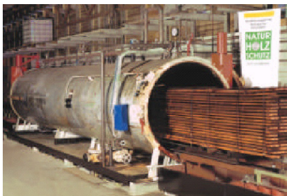
Slika 6: Postopke indirektnih sprememb izvajajo v vakuumsko tlačnih kotlih (Jones 2001)
