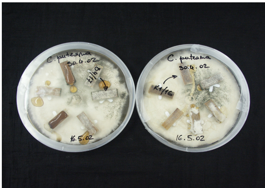
Slika 25: Mini blok test - Coniophora puteana , po prestavitvi na novo kulturo in osmih tednih preraščanja
