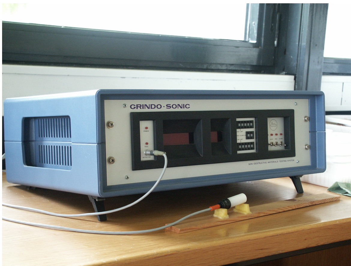
Slika 19: Grindo Sonic - naprava za merjenje frekvence, iz katere potem izračunamo modul elastičnosti
