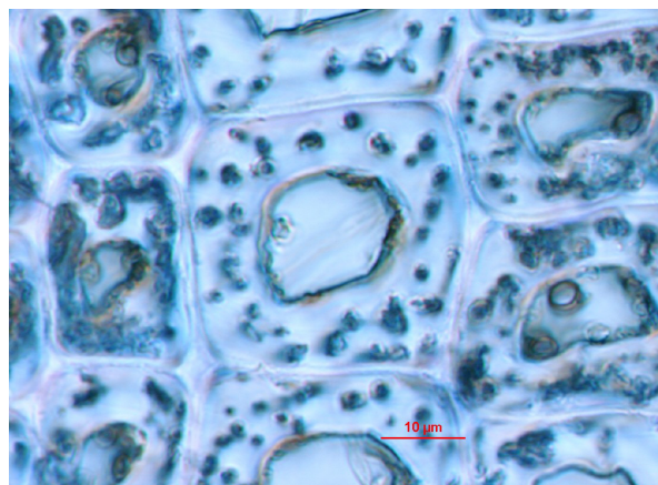
Sliki 45 in 46: Mikroskopska preparata vzorca bora po izpostavitvi zemlji in s tem neposredno glivam mehke trohnobe. Sliki prikazujeta značilne vdolbine v sekundarni steni pri rdečem boru (les iglavcev); vdolbine so v S 2 -sloju sekundarne stene.
