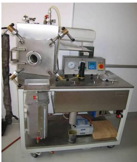
Slika 3: Vakuumska-tlačna komora KAMBIČ
