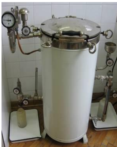
Slika 5: Avtoklav za sterilizacijo hranilnega gojišča in lesnih vzorcev
