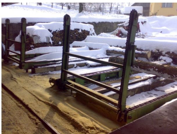
Slika 10: Prečni hlodovski verižni transporter z dvižno verižno mizo (Foto: H. Smrečnik)
