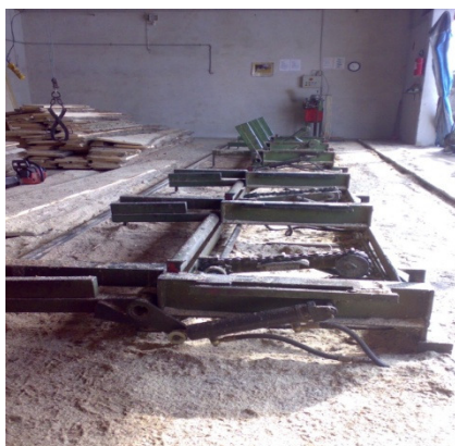
Slika 3: Nosilna okvirja z vpenjalno in verižno obračalno napravo ter z dviznim prislonom (Foto: H. Smrečnik)
