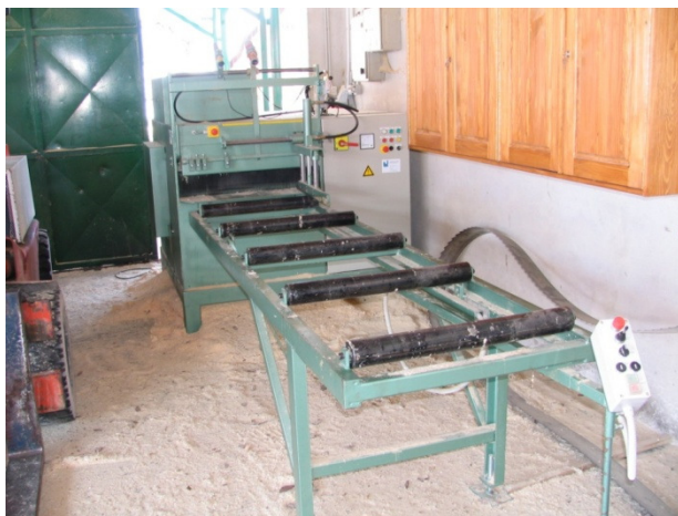
Slika 7: Robilno-cepilni krožni žagalni stroj (Leskovec, tip VLKŽ-900), (Foto: H. Smrečnik)
