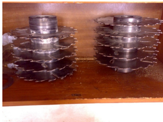
Sliki 8 in 9 : Fiksna in pomična vpenjalna glava ter vpenjalni glavi za cepljenje (Foto: H.Smrečnik)
