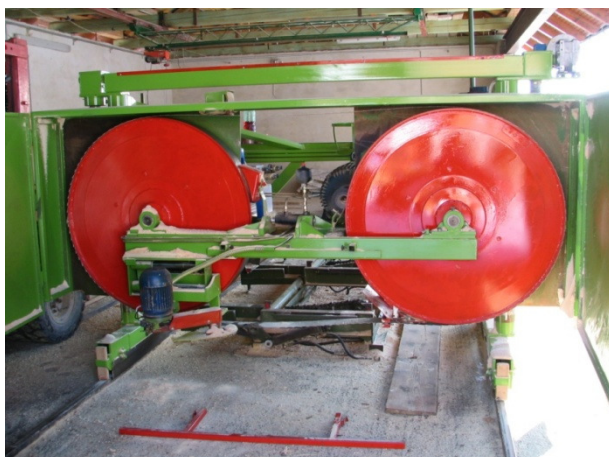
Slika 1: Horizontalni tračni žagalni stroj z napravo za pred rez (Foto: H. Smrečnik)
