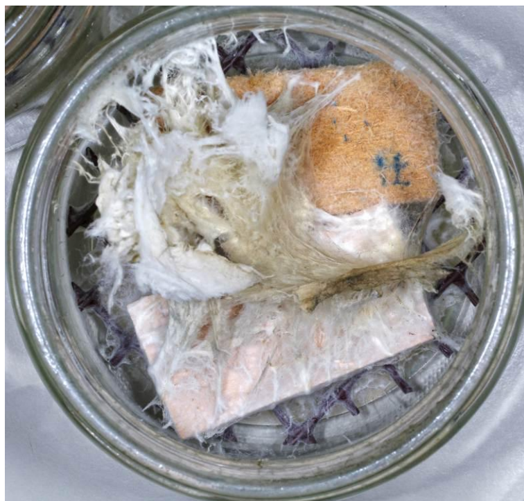
Slika 98: Delovanje bukovega ostrigarja na vzorec izolacijske plošče iz lesnih vlaken (LV4) 7ipv (zgoraj)
