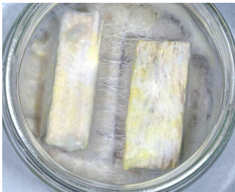
Slika 63: Delovanje sive hišne gobe na vzorec OSB gradbene plošče (OSB) 3osl (desno) in vzorec vezane plošče (VPLJ) 3vsl (levo)
