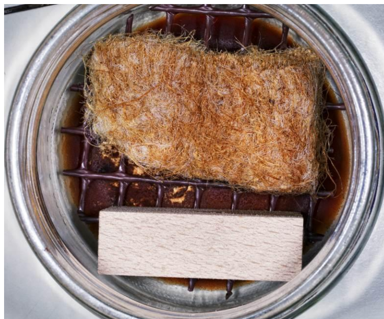
Slika 40: Delovanje navadne tramovke na vzorec izolacije iz konoplje (KON) 16kgt (zgoraj)
