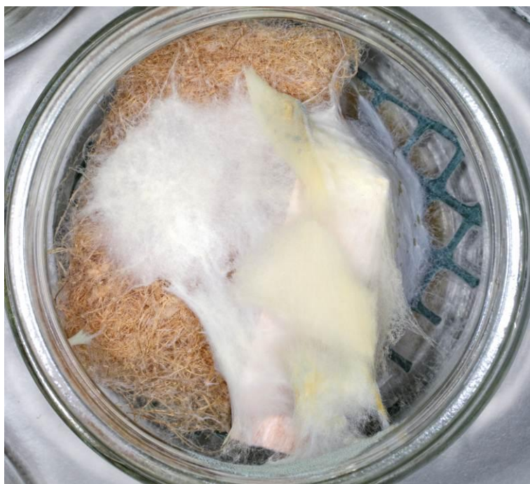
Slika 103: Delovanje bukovega ostrigarja na izolacijo iz konoplje (KON) 6kpV (levo)
