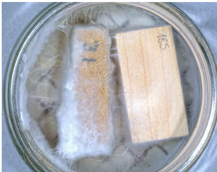
Slika 57: Delovanje sive hišne gobe na vzorec izolacijske plošče iz lesnih vlaken (LV4) 3isl (levo)
