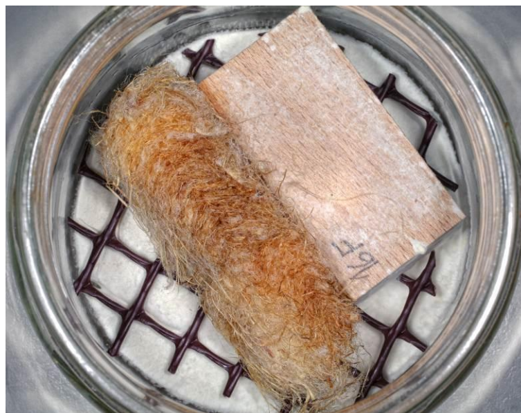
Slika 123: Delovanje pisane ploskocevk na izolacijo iz konoplje (KON) 21ktv (levo)
