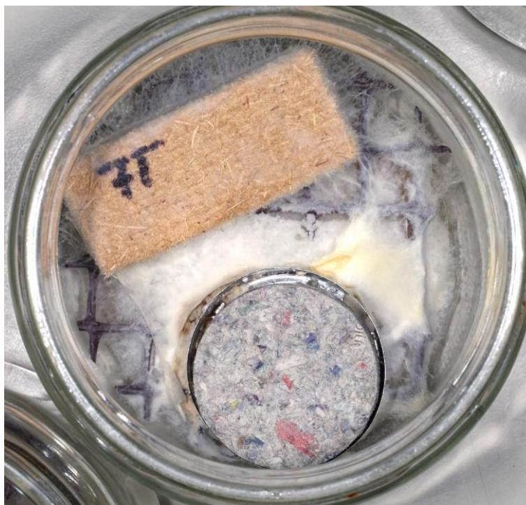
Slika 96: Delovanje bukovega ostrigarja na vzorec fasadno ploščo iz lesnih vlaken (LV3) 7tpv (zgoraj) in vzorec celulozno izolacijo za vpihovanje (CEL) 7 (spodaj)
