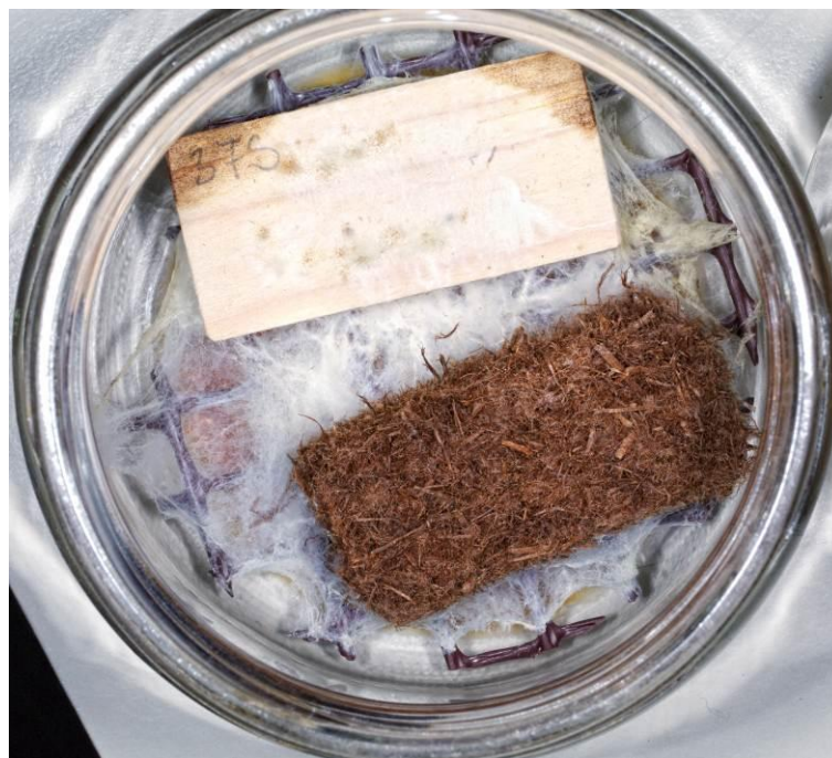
Slika 94: Delovanje bukovega ostrigarja na vzorec fleksibilne izolacije iz lesnih vlaken (LV2) 7rpv (spodaj)
