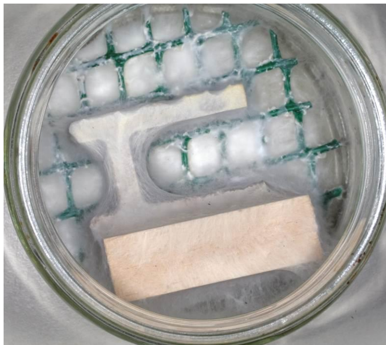
Slika 6: Delovanje bele hišne gobe na vzorec Lesnega polimernega kompozita (WPC3) 27cav (zgoraj)
