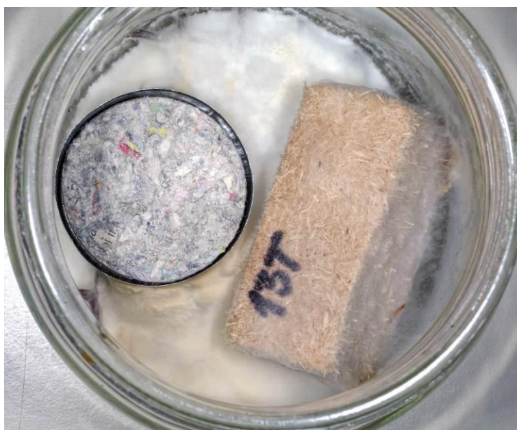
Slika 75: Delovanje ogljene kroglice na vzorec fasadne plošče iz lesnih vlaken (LV3) 13tht (desno) in vzorec celulozne izolacije za vpihovanje (CEL) 13 (levo)
