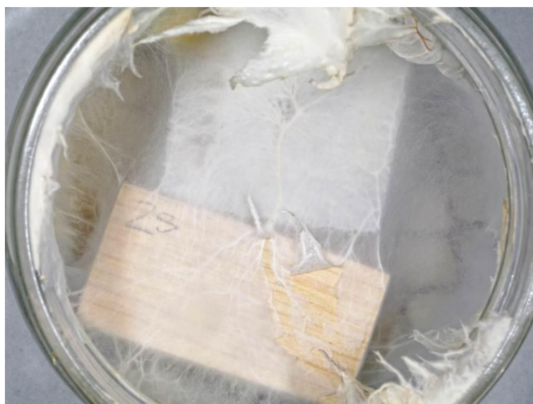
Slika 49: Delovanje sive hišne gobe na vzorec lesni polimerni kompozit (WPC3) 2ssl (zgoraj)
