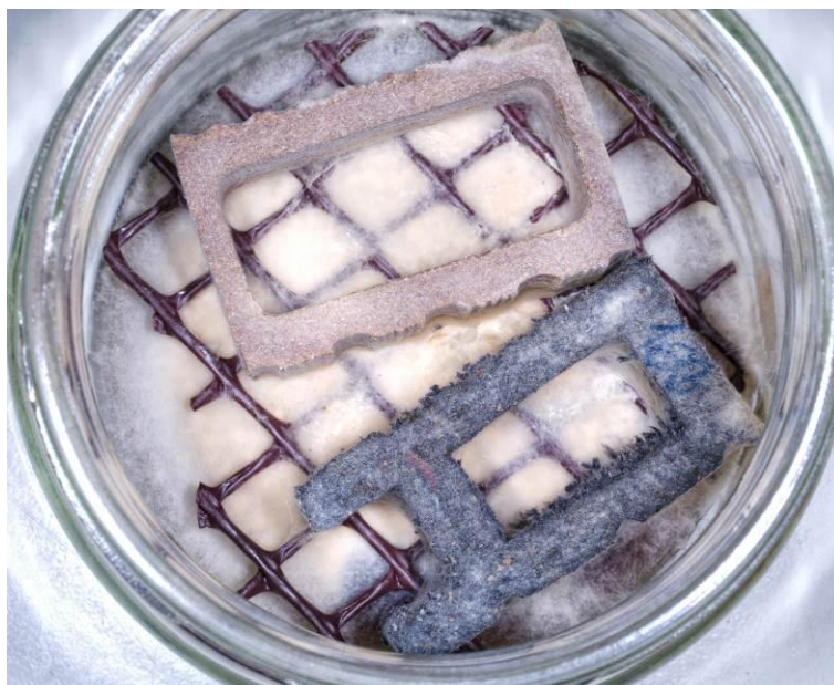
Slika 24: Delovanje navadne tramovke na Lesni polimerni kompozit (WPC1) 16agt (zgoraj) in lesni polimerni kompozit (WPC2) 16bgt (spodaj)
