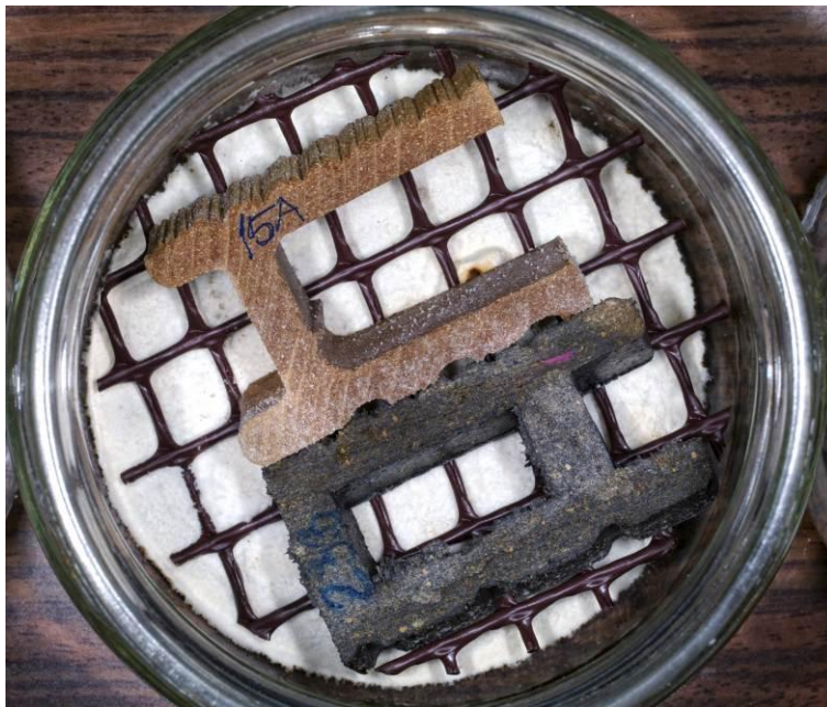
Slika 109: Delovanje pisane ploskocevke na vzorec lesnega polimernega kompozita (WPC1) 15atv (zgoraj) in vzorec lesnega polimernega kompozita (WPC2) 23btv (spodaj)
