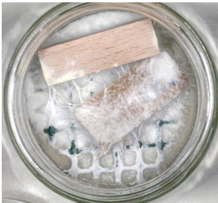
Slika 15: Delovanje bele hišne gobe na vzorec plošče iz lesnih vlaken za zvočno izolacijo (LV5) 27zva (spodnji vzorec)
