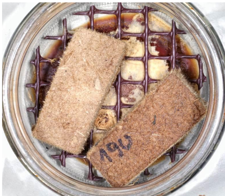
Slika 29: Delovanje navadne tramovke na vzorec izolacijske plošče iz lesnih vlaken (LV1) 19mgt (levo) in vzorec izolacijske plošče iz lesnih vlaken (LV6) 19ugt (desno)
