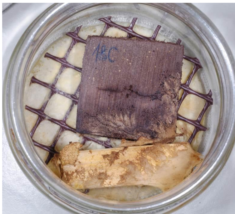
Slika 27: Delovanje navadne tramovke na vzorec Lesnega polimernega kompozita (WPC3) 18cgt (zgoraj)
