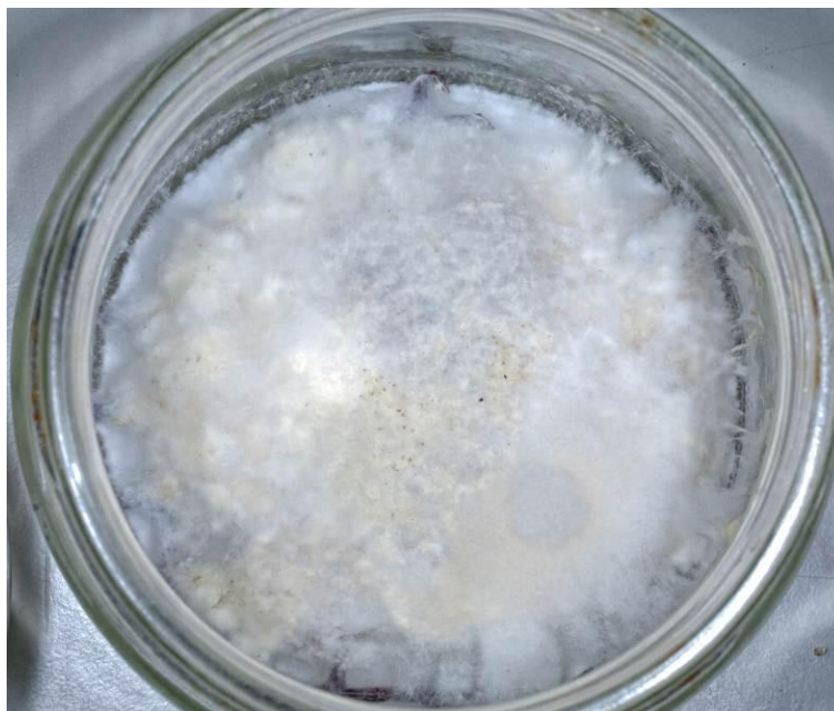
Slika 78: Delovanje ogljene kroglice na vzorec plošče iz lesnih vlaken za zvočno izolacijo (LV5) 12zht (zgoraj)
