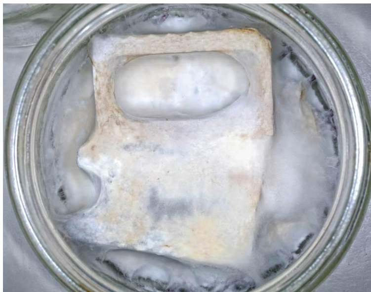
Slika 67: Delovanje ogljene kroglice na vzorec lesnega polimernega kompozita (WPC1) 14aht (zgoraj) in vzorec Lesnega polimernega kompozita (WPC2) 14bht (spodaj)
