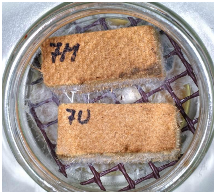
Slika 92: Delovanje bukovega ostrigarja na vzorec izolacijske plošče iz lesnih vlaken (LV1) 7mpv (zgoraj) in vzorec izolacijske plošče iz lesnih vlaken (LV6) 7upv (spodaj)
