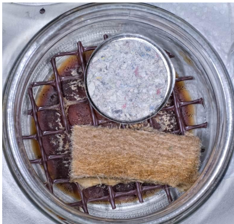
Slika 33: Delovanje navadne tramovke na vzorec fasadne plošče iz lesnih vlaken (LV3) 19tgt (spodaj) in vzorec CEL 19 (zgoraj)
