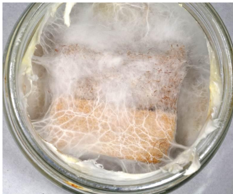
Slika 53: Delovanje sive hišne gobe na vzorec fleksibilne izolacije iz lesnih vlaken (LV2) 3rsl (zgoraj) in vzorec izolacijske plošče iz lesnih vlaken (LV6) 3usl (spodaj)
