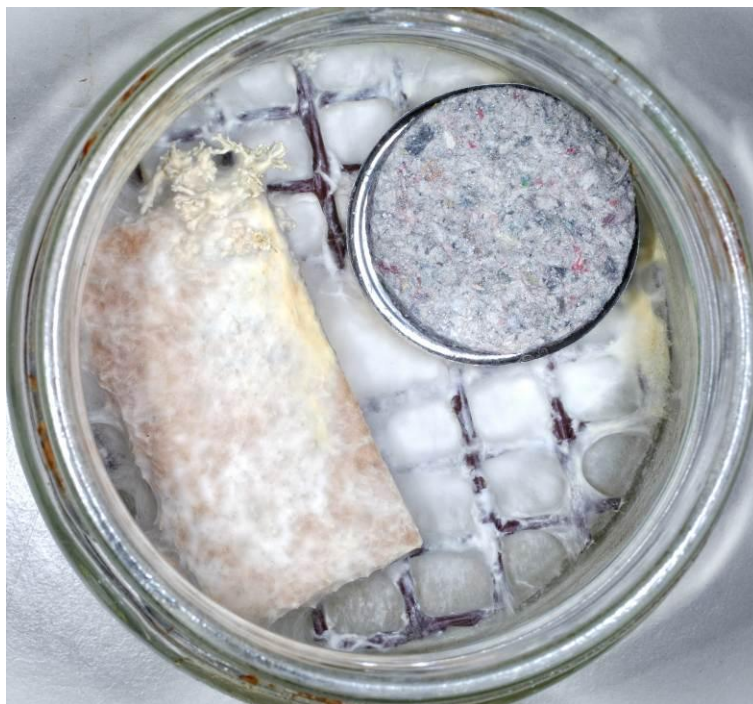
Slika 13: Delovanje bele hišne gobe na vzorec izolacijske plošče iz lesnih vlaken (LV4) 28iav (levo) in vzorec celulozne izolacije za vpihovanje (CEL) 30 (desno)
