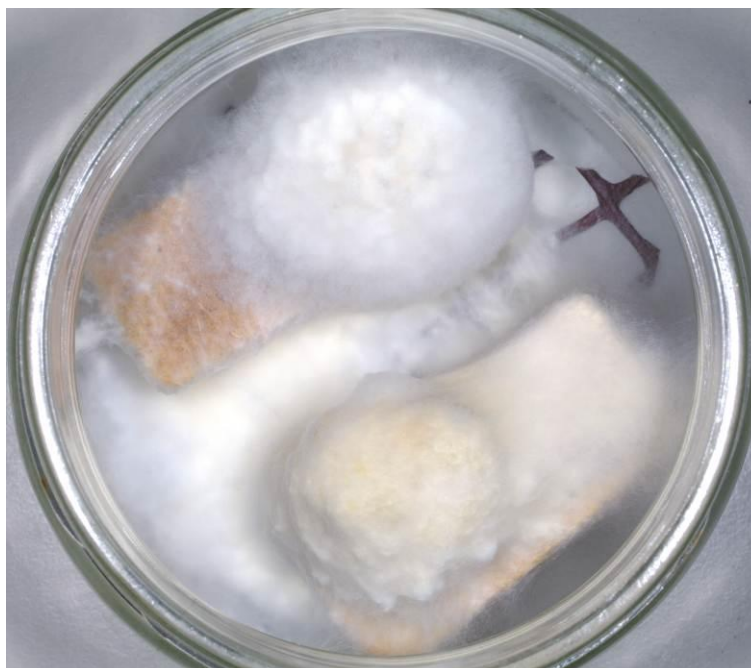
Slika 72: Delovanje ogljene kroglice na vzorec izolacijske plošče iz lesnih vlaken (LV1) 13mht (spodaj) in vzorec izolacijske plošče iz lesnih vlaken (LV6) 13uht (zgoraj)
