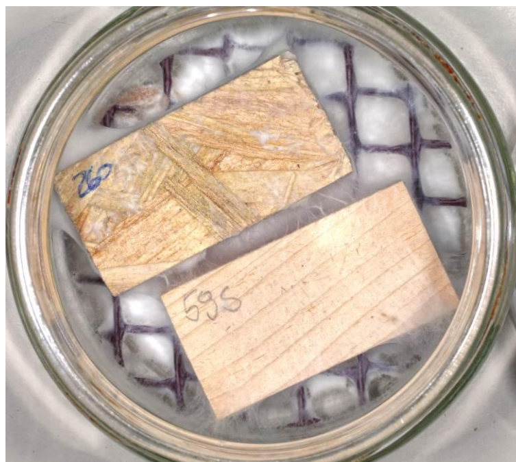
Slika 20: Delovanje bele hišne gobe na vzorec OSB gradbene plošče (OSB) 25oav (zgoraj)
