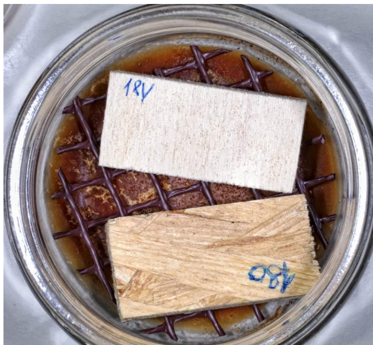
Slika 42: Delovanje navadne tramovke na vzorec OSB gradbene plošče (OSB) 18ogt (spodaj) in vzorec vezane plošče (VPLJ)
