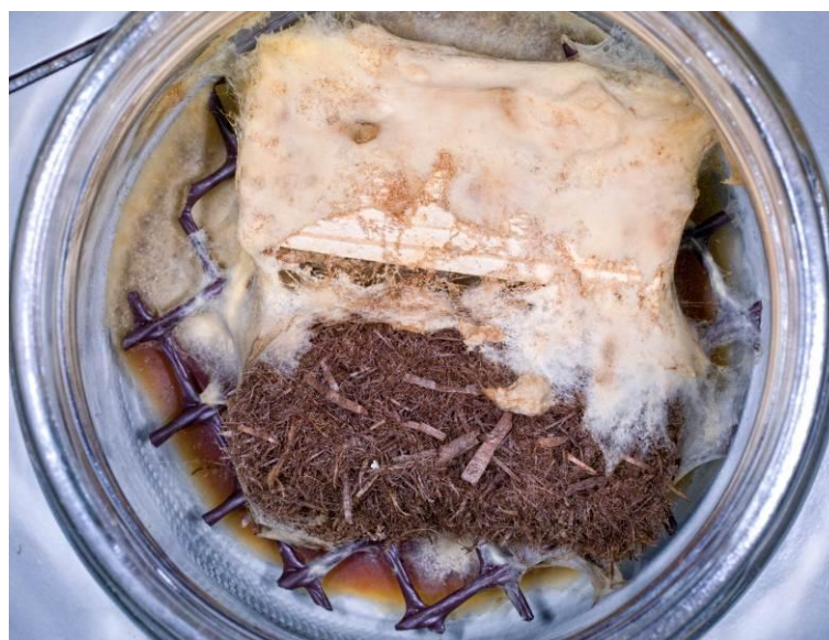
Slika 31: Delovanje navadne tramovke na vzorec fleksibilna izolacija iz lesnih vlaken (LV2) 17rgt (spodaj)
