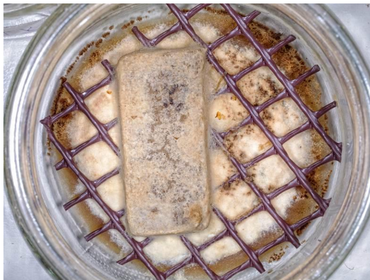
Slika 37: Delovanje navadne tramovke na vzorec plošče iz lesnih vlaken za zvočno izolacijo (LV5) 16zgt
