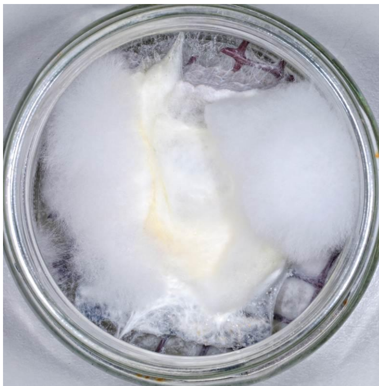
Slika 87: Delovanje bukovega ostrigarja na vzorec lesnega polimernegai kompozita (WPC1) 9apv (zgoraj) in vzorec lesnega polimernegai kompozita (WPC2) 9bpv (spodaj)
