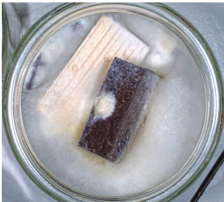
Slika 70: Delovanje ogljene kroglice na vzorec lesnega polimernega kompozita (WPC3) 11cht (desno)
