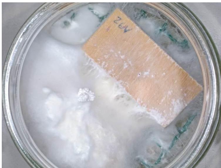
Slika 9: Delovanje bele hišne gobe na vzorec fleksibilne izolacije iz lesnih vlaken (LV2) 26rva (spodaj) in vzorec vezane plošče (VPLJ) 26vav (zgoraj)
