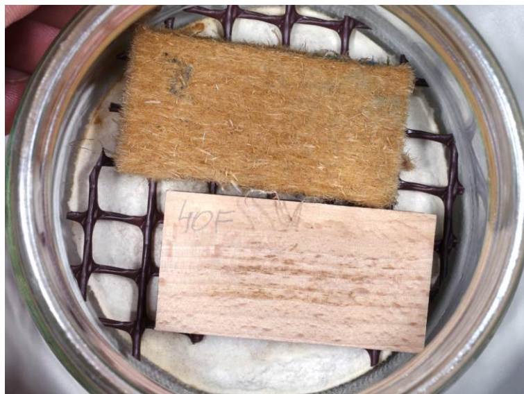
Slika 118: Delovanje pisane ploskovecke na vzorec izolacijske plošče iz lesnih vlaken (LV4) 23itv (zgoraj)
