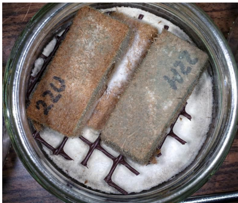
Slika 114: Delovanje pisane ploskocevke na vzorec izolacijske plošče iz lesnih vlaken (LV1) 22mtv (desno) in vzorec izolacijske plošče iz lesnih vlaken (LV6) 22utv (levo)
