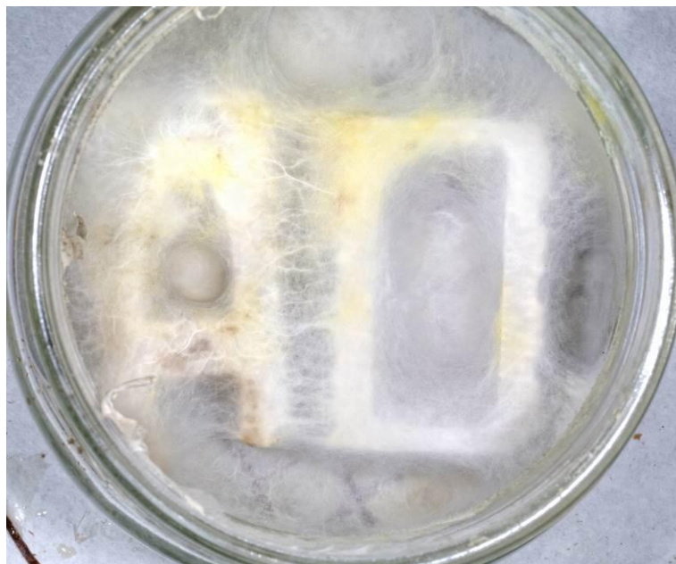
Slika 46: Delovanje sive hišne gobe na vzorec lesnega polimernega kompozita (WPC1) 3asl (desno) in vzorec lesnega polimernega kompozita (WPC2) 3bsl (levo)
