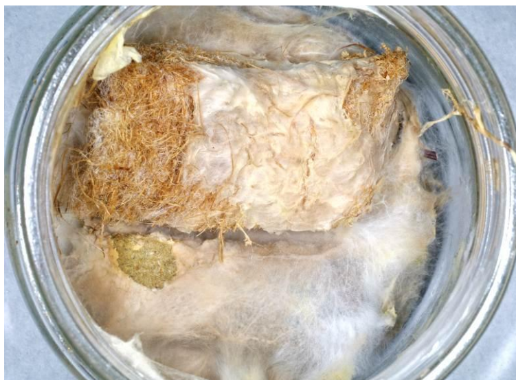
Slika 61: Delovanje sive hišne gobe na izolacijo iz konoplje (KON) 4ksl (zgoraj) in vzorec plošče iz lesnih vlaken za zvočno izolacijo (LV5) 4zsl (spodaj)
