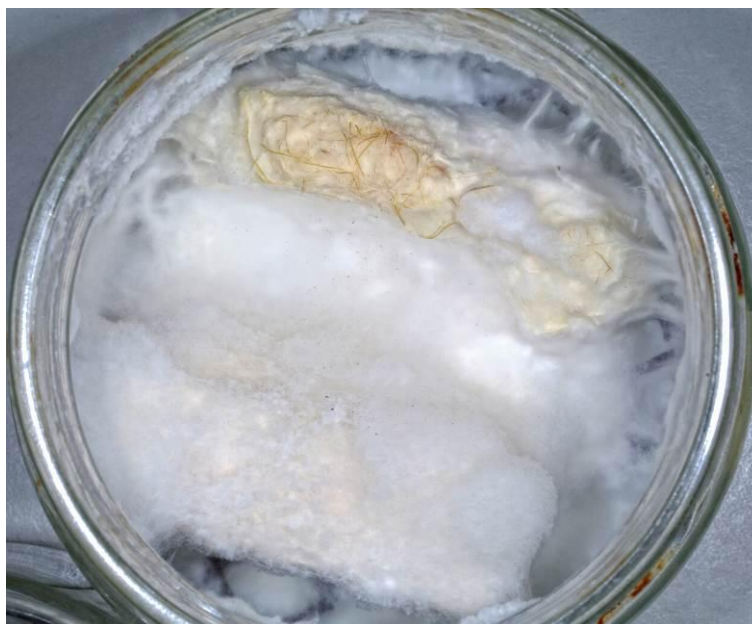
Slika 81: Delovanje ogljene kroglice na izolacijo iz konoplje (KON) 13kht (zgoraj)
