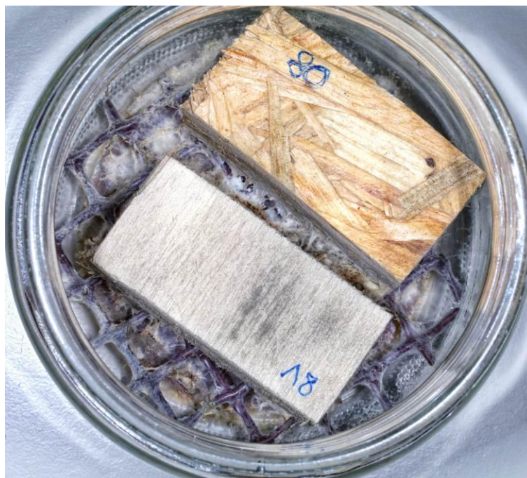
Slika 105: Delovanje bukovega ostrigarja na vzorec OSB gradbene plošče (OSB) 8opv (zgoraj) in vzorec vezane plošče (VPLJ) 8vpv (spodaj)
