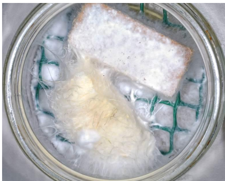
Slika 18: Delovanje bele hišne gobe na izolacijo iz konoplje (KON) 28kav (spodaj) in vzorec izolacijske plošče iz lesnih vlaken (LV1) 30mav (zgoraj)
