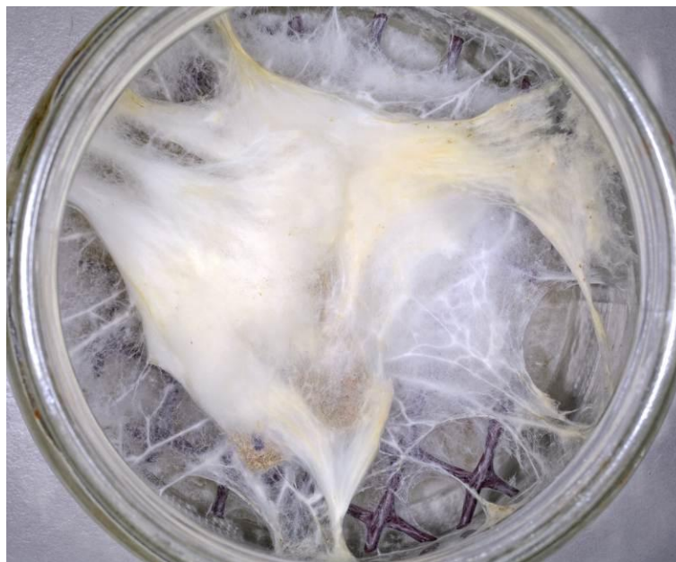
Slika 100: Delovanje bukovega ostrigarja na vzorec plošče iz lesnih vlaken za zvočno izolacijo (LV5) 7zpv
