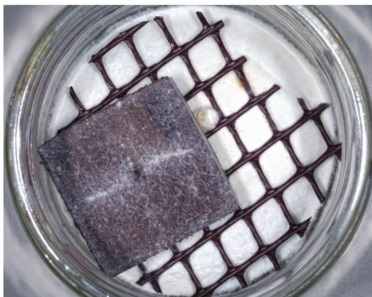
Slika 112: Delovanje pisane ploskocevke na vzorec lesnega polimernega kompozita (WPC3) 23ctv
