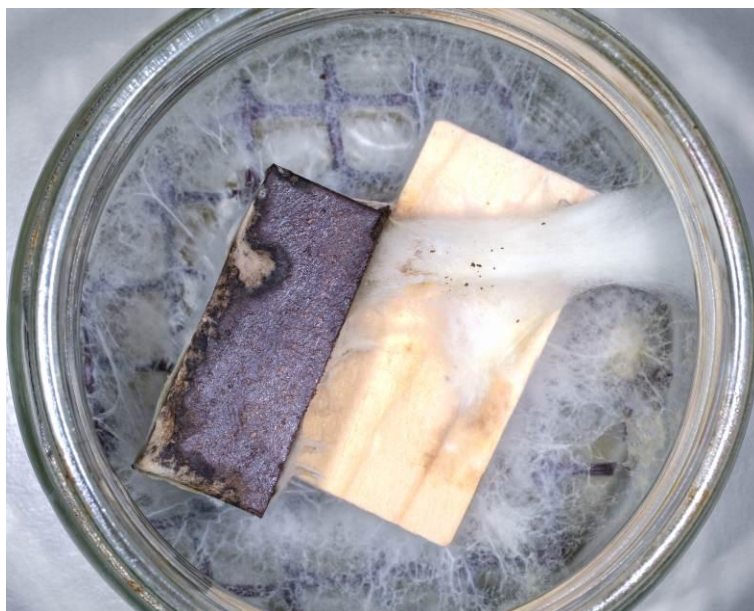
Slika 90: Delovanje bukovega ostrigarja na lesni polimerni kompozit (WPC3) 9cpv (levo)
