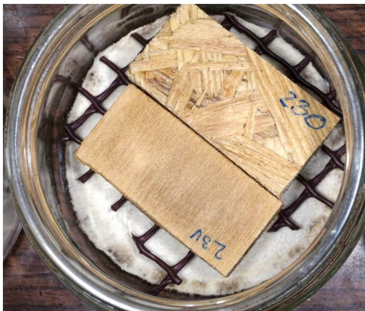
Slika 125: Delovanje pisane ploskocevke na vzorec OSB gradbene plošče (OSB) 23otv (zgoraj) in vzorec vezane plošče 23vtv (spodaj)
