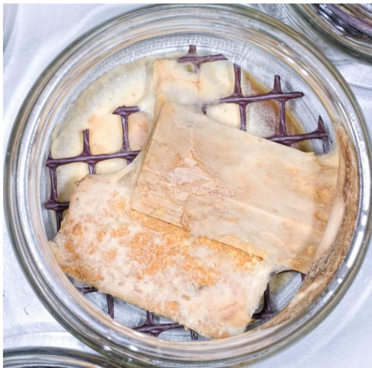
Slika 35: Delovanje navadne tramovke na vzorec izolacijske plošče iz lesnih vlaken (LV4) 19igt (spodaj)
