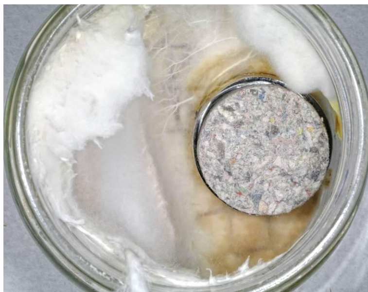
Slika 51: Delovanje sive hišne gobe na vzorec izolacijske plošče iz lesnih vlaken (LV1) 4msl (levo) in vzorec celulozne izolacije za vpihovanje (CEL) 4 (desno)
