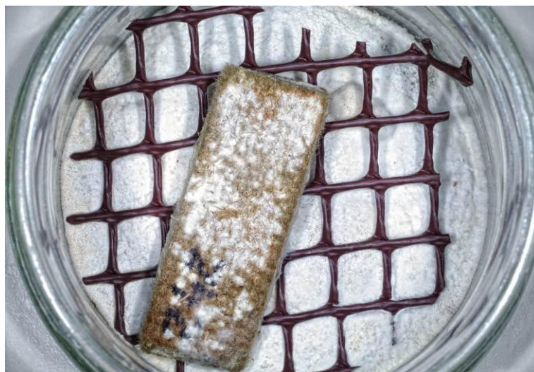
Slika 120: Delovanje pisane ploskocevke na vzorec plošče iz lesnih vlaken za zvočno izolacijo (LV5) 24ztv
