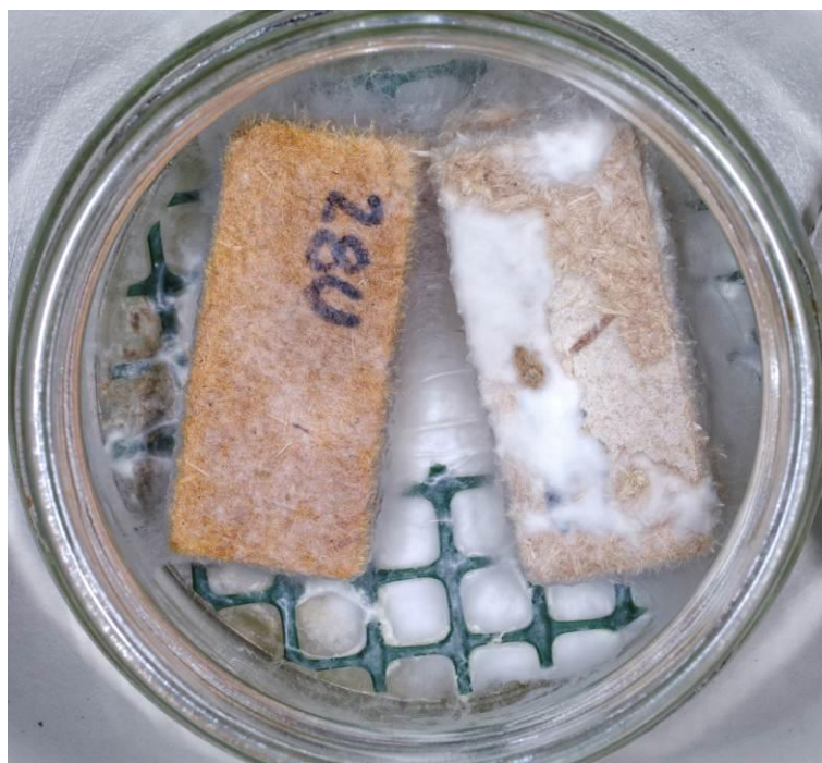
Slika 11: Delovanje bele hišne gobe na vzorec fasadne plošče iz lesnih vlaken (LV3) 29tva (desno) in vzorec izolacijske plošče iz lesnih vlaken (LV6) 28uav (levo)
