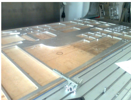
Slika 34: Ostanek plošče po izrezovanju potrebnih elementov
