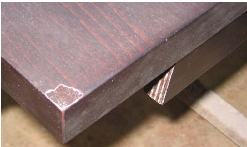
Slika 8: Poškodovan vogal plošče
