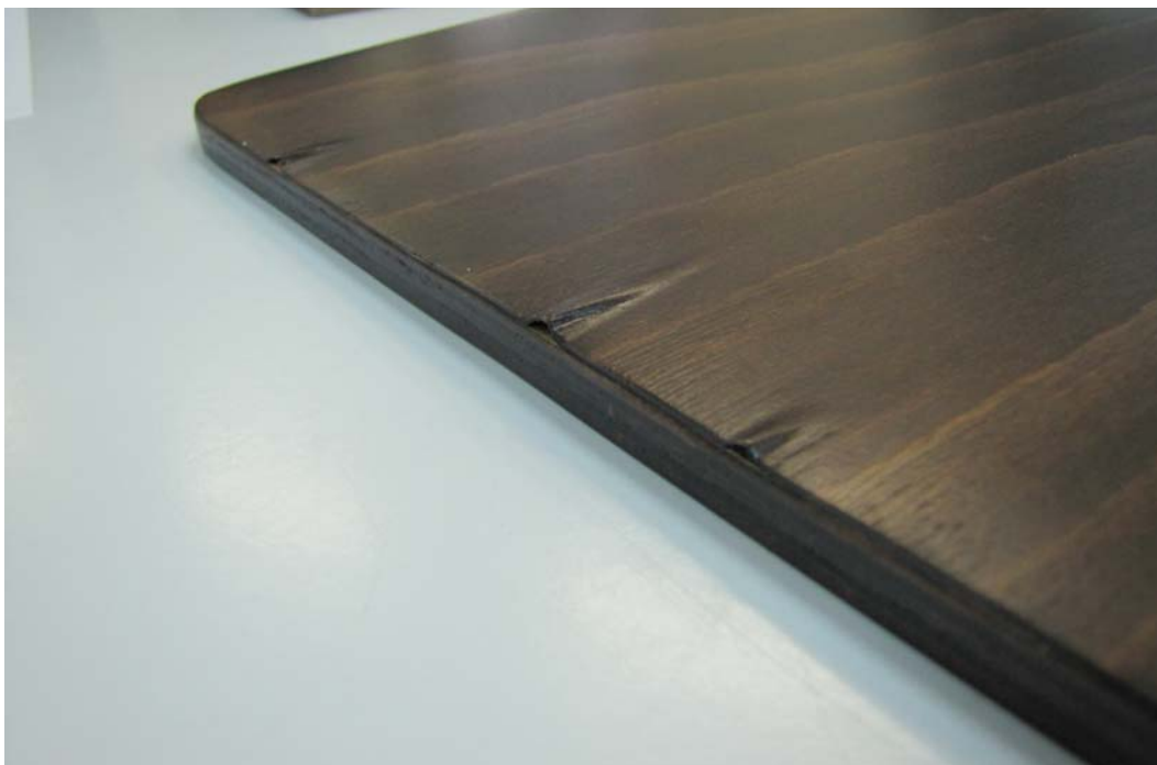
Slika 7: Poškodovana površina sedeža iz vezane plošče
