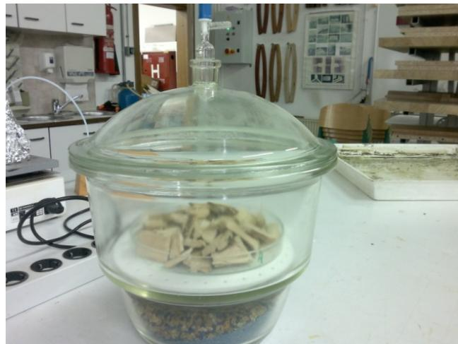
Slika 21: Prikazuje ohlajanje vzorcev v desikatorju z silikagelom
