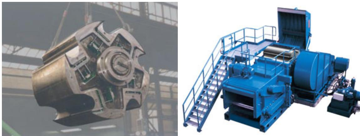
Slika 12: Sekalnik HRL 2000 in boben sekalnika z petimi noži (Sekalnik Maier, 2011)
