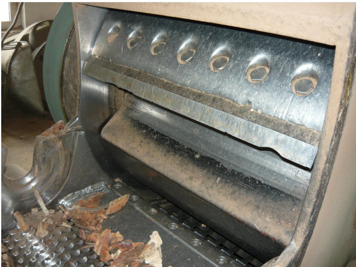
Slika 19: Rezalni nož sekalnika
