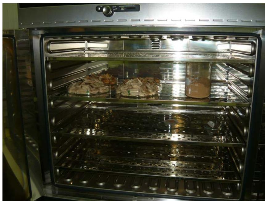
Slika 20: Sušenje vzorcev v laboratorijskem sušilniku
