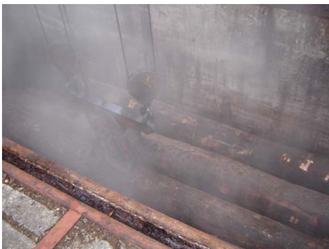
Slika 4: Parilna jama; pogled v notranjost parilne jame, kjer so nameščeni hlodi za parjenje
