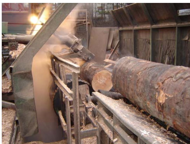
Slika 2: Stroj z rezkalno glavo za lupljenje furnirske hlodovine
