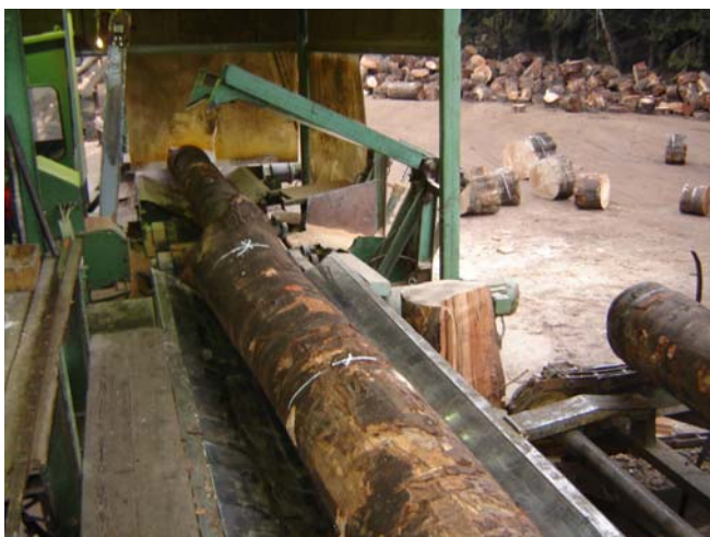
Slika 5: Stacionarni verižni žagalni stroj za krojenje hlodov na željeno dolžino
