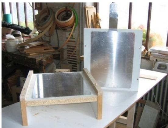
Slika 6: Izgled Al plošče kondenzatorja za VF segrevanje preskušancev
