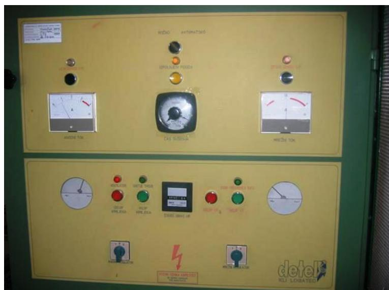
Slika 13: Prikaz nastavitev na kontrolni plošči VF generatorja.
