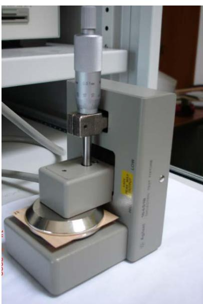
Slika 10: Sonda AGILENT 16451B za merjenje dielektričnih lastnosti materialov z zračno režo
