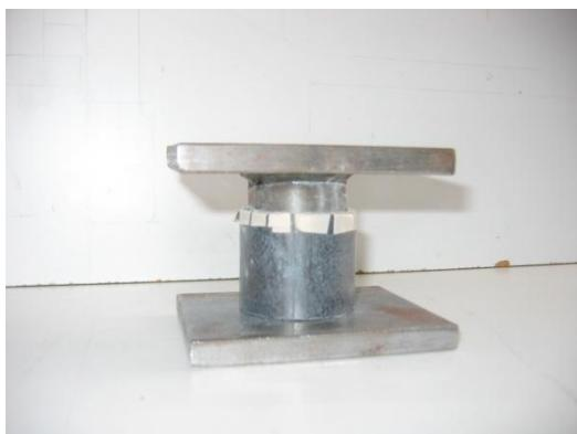
Slika 8: Naprava za stiskanje praškastega premaza in pripravkov
