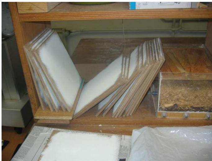
Slika 18: Vzorci MDF plošče s staljenim praškastim premazom
