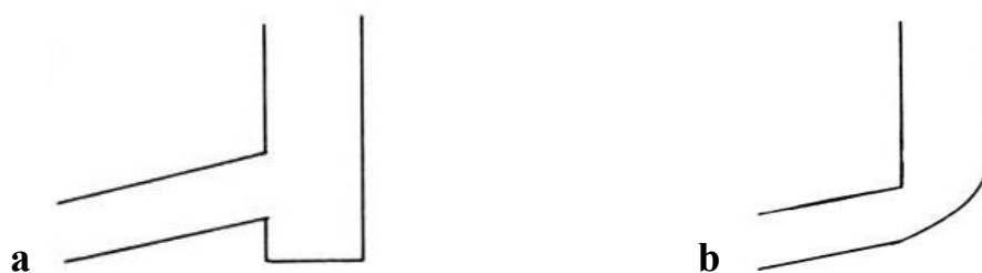
Slika 2: Vtočni jašek (a – s peskolovom, b – z zaobljenim dnom) (Šavelj, 1992)
