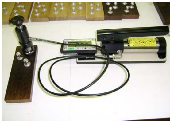
Slika 7: Naprava za odtrgovanje pečatov
