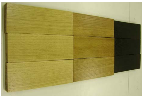
Slika 17: Barvna sprememba, na vzorcih, prelakiranih s PU lakom, ki je nastala zaradi modifikacije (kontrolni, T_1 150 °C in T_2 200 °C, od leve proti desni)
