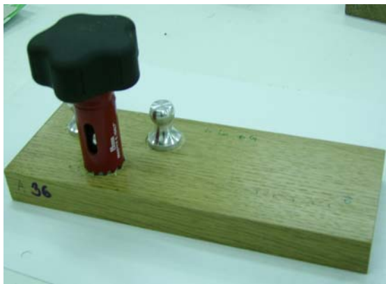
Slika 6: Zarezovanje filma premaza okoli pečatov do podlage s kronskim rezilom
