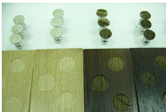
Slika 14: Odrtni pečati z različnih podlag ( T_1 150 °C - levo in T_2 200 °C - desno)
