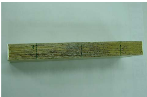
Slika 15: Odstopanje laka z nemodificirane podlage po 24 urah izpostavitve obremenitvi (kontrolni vzorec)
