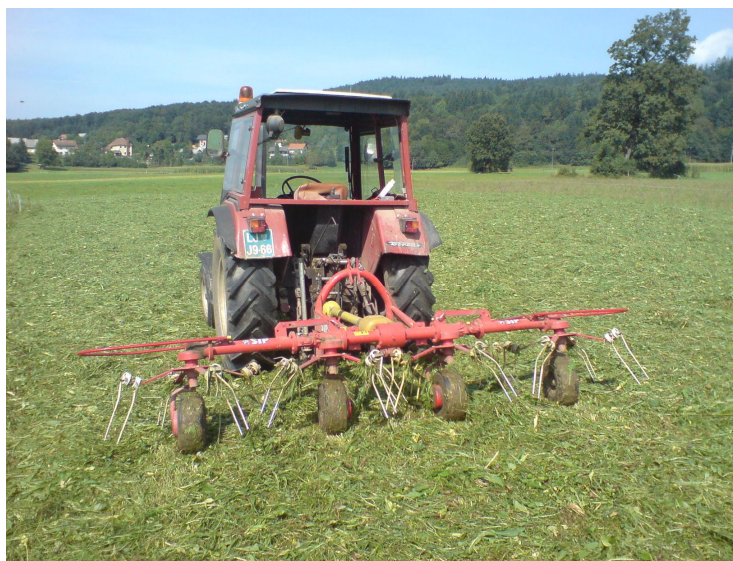
Slika 14: Vrtavkasti obračalnik (foto: Blaž Svet, 2008)
