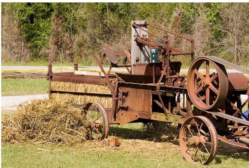
Slika 1: Stacionarna naprava za izdelavo kvadrastih bal (Flemming, 2006)
