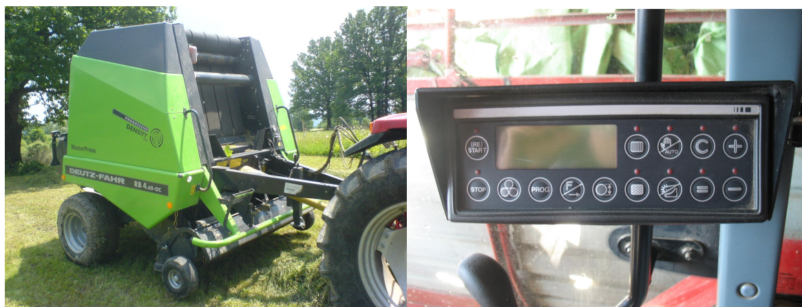
Slika 22: Balirka Deutz Fahr RB 4.60 in njena upravljalna enota (foto: Blaž Svet, 2008)
