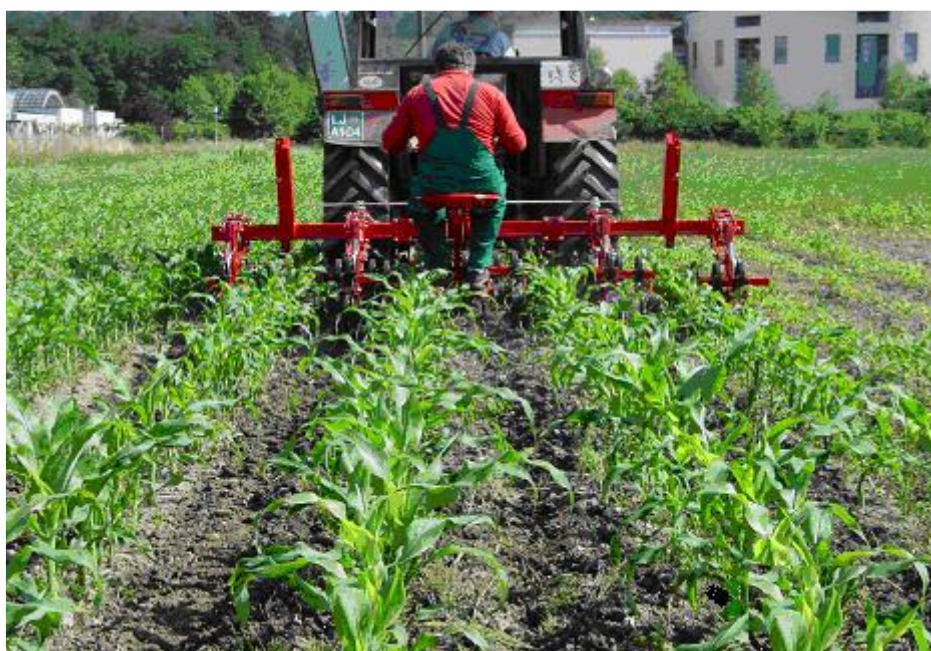
Slika 22: Vlečeni okopalnik z elastičnimi nogačami na paralelogramskem ogrodju
