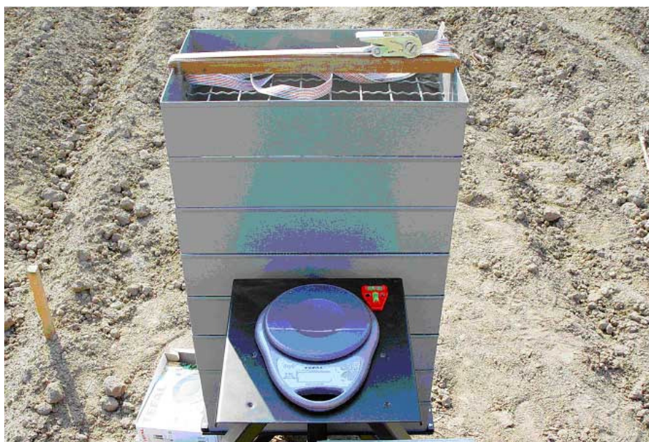
Slika 30: Meritev strukture talnih delcev na stresalni napravi z okvirjem
