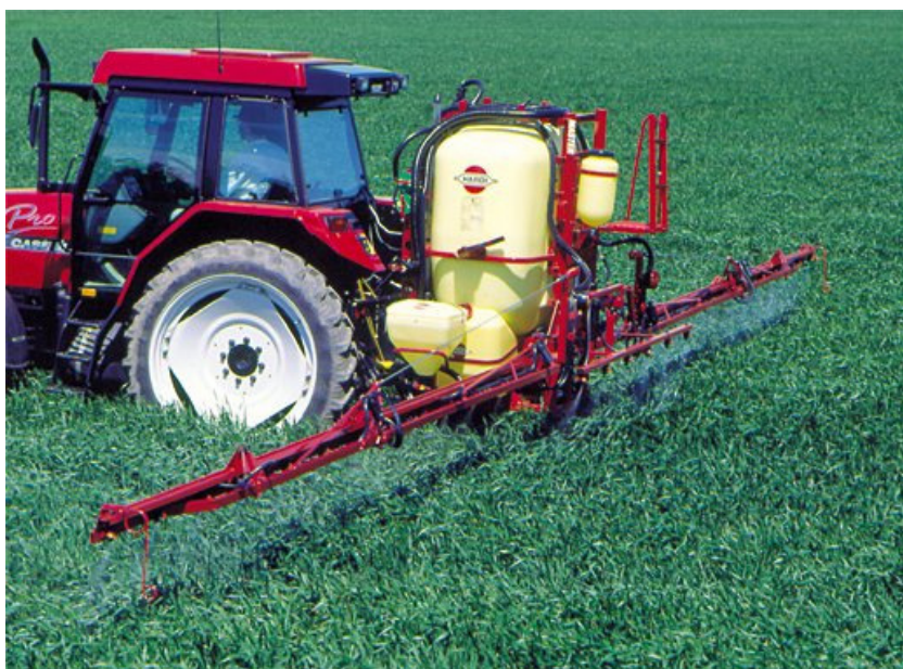
Slika 11: Škropilnica z delovno širino 12 m (Landmaschinen Katalog, 2002)
