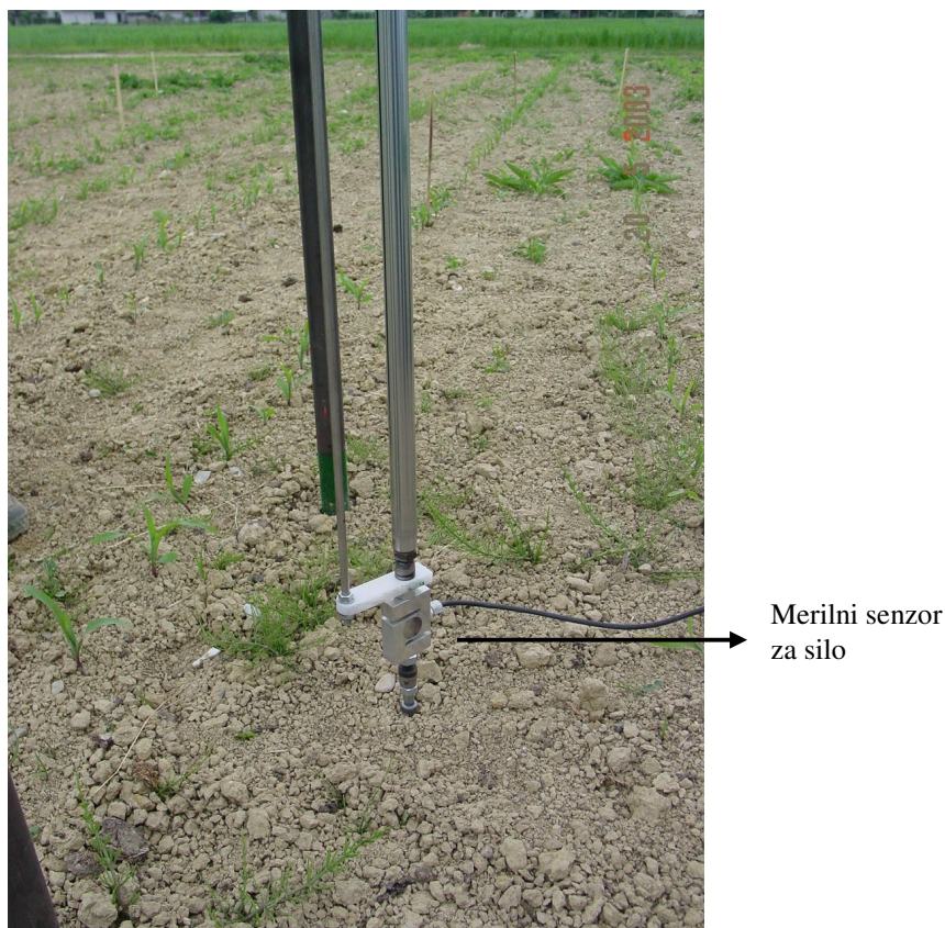
Slika 28: Potek meritve na sredini medvrstnega prostora
