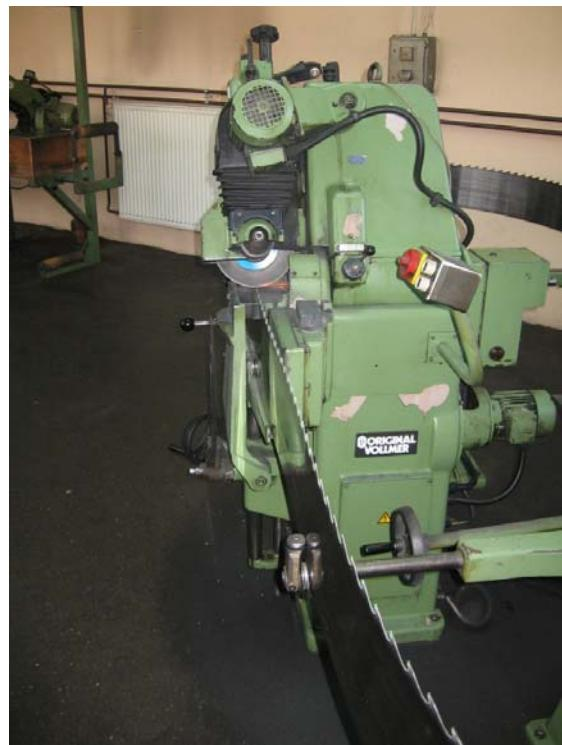
Slika 27: Stroj za brušenje žaginih listov
