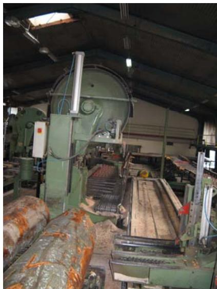
Slika 17: Tračni žagalni stroj »Stenner« z vozičkom
