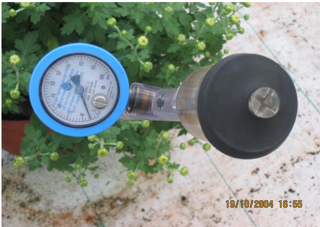
Slika 9: Tenziometer, ki je bil nameščen v lončku, za merjenje vlage v tleh.
