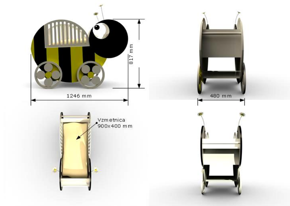
Slika 10. Zunanje dimenzije otroške zibke
