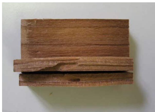
Slika 10: Poškodba vzorca borovine (termična modifikacija 170 °C, brez reagenta). Foto. Marko Uršič
