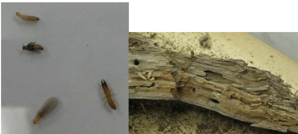
Slika 4: Prikaz vojaka, imaga s krili, nimfe in delavca zgoraj (slika levo). Napaden les z rumenovratim termitom (slika desno). Foto: Marko Uršič.
