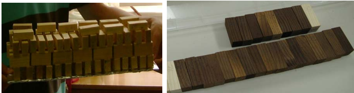
Slika 8: Vzorci, pripravljene na termično modifikacijo (levo), termično obdelani in dva neobdelana vzorca (desno). Foto. Marko Uršič
