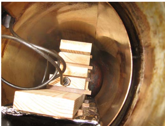
Slika 3: Notranjost vakuumske tlačne komore
