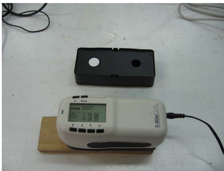
Slika 2: Merilni aparat (Spektrofotometer X-Rite SP 62) za merjenje barve
