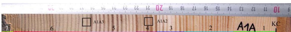
Slika 18: Jelka (*Abies alba* Mill.), makroskopska slika vzorca A1A – lokaciji odvzema vzorcev za anatomska preparata A1A2 in A1A3.
