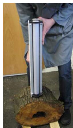
Slika 14: Vrtanje Resistographom F500 v vzorec lipa T3.
