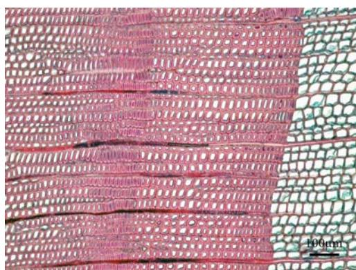
Slika 42: Navadna smreka (*Picea abies* (L.) Karst.), prečni prerez vzorca P1C1 – dve plasti kasnega lesa.
