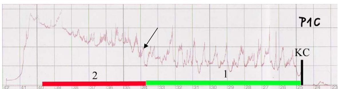
Slika 40: Navadna smreka (*Picea abies* (L.) Karst.), krivulja signala Resistographa F500 pri vzorcu P1C – puščica prikazuje signal, ki ustreza lokaciji kasnega lesa na preparatu P1C1 (Slika 42).
