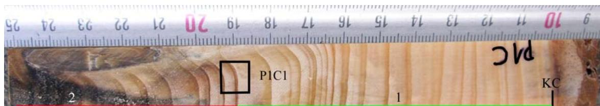
Slika 39: Navadna smreka (*Picea abies* (L.) Karst.), makroskopska slika vzorca P1C – lokacija odvzema vzorca za anatomskejki preparat P1C1.
