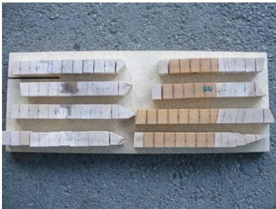
Slika 16: Razdelitev radialnih vzorcev na manjše vzorce debeline 5 do 15 mm.
