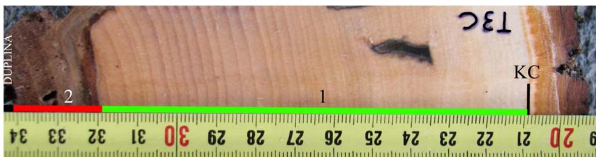
Slika 115: Lipa (*Tilia* spp.), makroskopska slika vzorca T3C.
