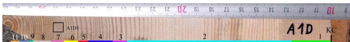
Slika 28: Jelka (*Abies alba* Mill.), makroskopska slika vzorca A1D – lokacija odvzema vzorca za anatomski preparat A1D1.
