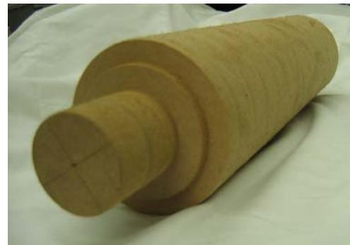
Slika 3-19. Masivni preizkušanec normalne vlažnosti in MDF preizkušanec
