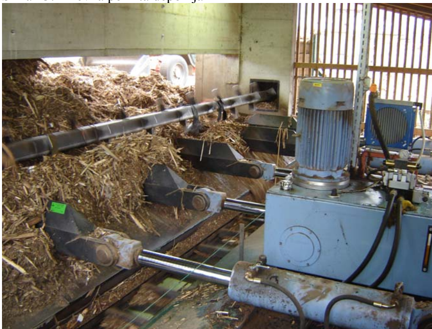
Slika 14: Hidravlične nakladalne grablje v pokriti deponiji
