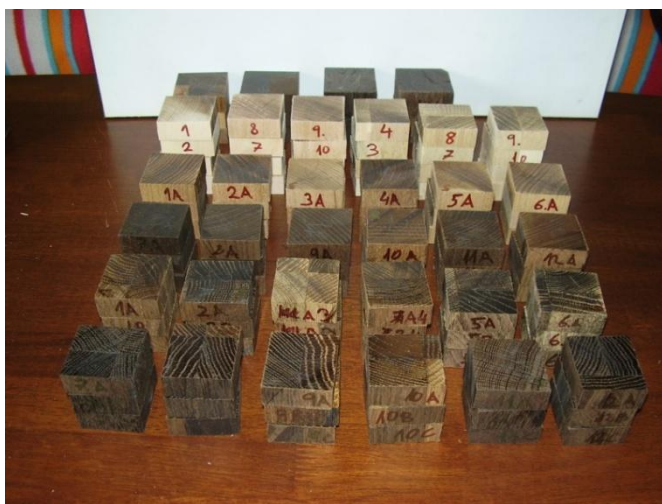
Slika 2: Vzorci lesa hrasta in bukovine za preverjanje dimenzijske stabilnosti
