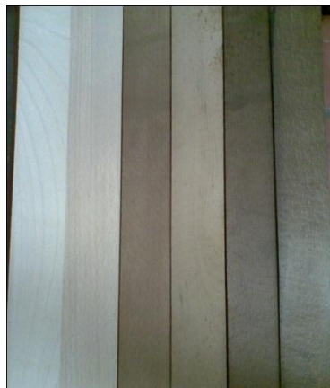
Slika 4: Barvna razlika kontrolnega, modificiranega pri 170 °C in 200 °C, hrastovega in bukovega lesa
