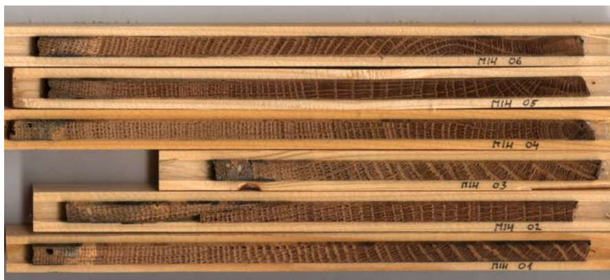
Slika 51: Izvrtki iz objekta Divjakov toplar
