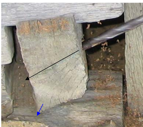
Slika 73: Prikaz smeri odvzema izvrtka in branik, ki niso zajete v izvrtek
