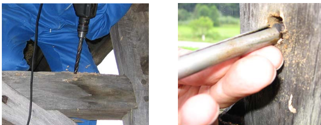
Slika 37: Vrtanje izvrtka– levo, izvek izvrtka za dendrokronološko analizo - desno
