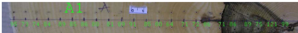
Slika 92: Javor ( Acer pseudoplatanus L.), makroskopski posnetek vzorca A1A, z označenimi lokacijami meritev vertikalne električne upornosti.
