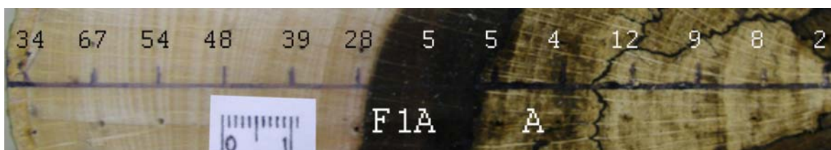
Slika 80: Navadna bukev ( Fagus sylvatica L.), makroskopski posnetek vzorca F1A A, z označenimi lokacijami meritev vertikalne električne upornosti.
