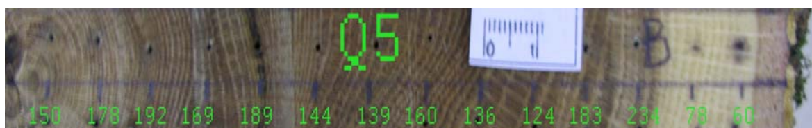
Slika 60: Hrast ( Quercus spp. L.), makroskopski posnetek vzorca Q5B, z označenimi lokacijami meritev vertikalne električne upornosti.
