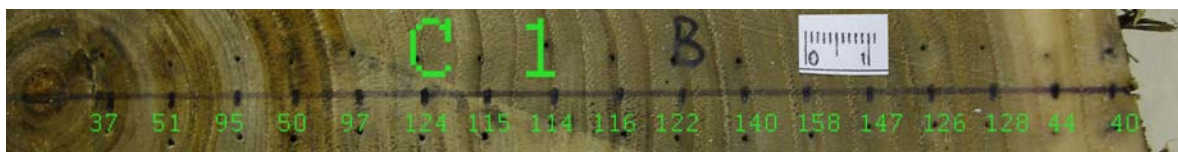
Slika 7: Domači kostanj ( Castanea sativa Mill.), makroskopski posnetek vzorca C1B, z označenimi lokacijami meritev vertikalne električne upornosti.
