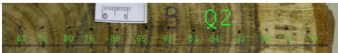
Slika 48: Hrast ( Quercus spp. L.), makroskopski posnetek vzorca Q2B, z označenimi lokacijami meritev vertikalne električne upornosti.
