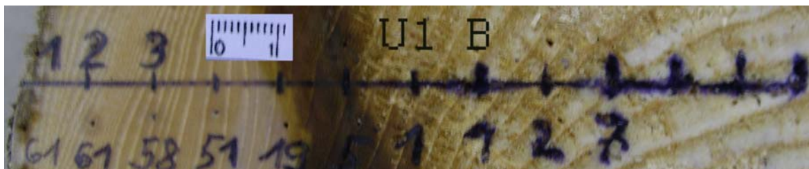
Slika 25: Brest ( Ulmus glabra Huds.), makroskopski posnetek vzorca U1B, z označenimi lokacijami meritev vertikalne električne upornosti.
