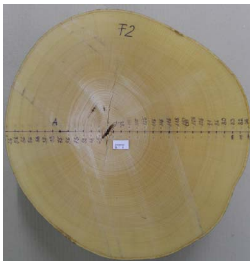
Slika 3: Bukev ( Fagus sylvatica L.) – označitev lokacij za merjenje vertikalne električne upornosti (zapisane so tudi meritve, ki smo jih opravili).
