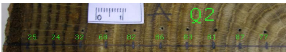
Slika 51: Hrast ( Quercus spp. L.), makroskopski posnetek vzorca Q2A, z označenimi lokacijami meritev vertikalne električne upornosti.
