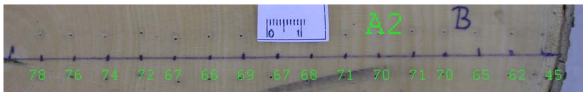
Slika 97: Javor ( Acer pseudoplatanus L.), makroskopski posnetek vzorca A2B, z označenimi lokacijami meritev vertikalne električne upornosti.
