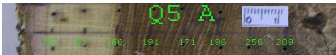
Slika 63: Hrast ( Quercus spp. L.), makroskopski posnetek vzorca Q5A, z označenimi lokacijami meritev vertikalne električne upornosti.
