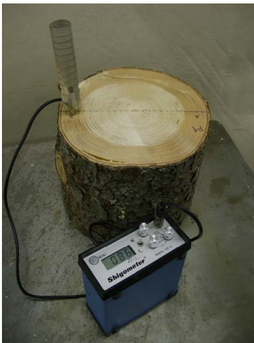
Slika 4: Navadna smreka ( Picea abies (L.) Karst) vertikalna meritev električne upornosti na vzorcu navadne smreke.
