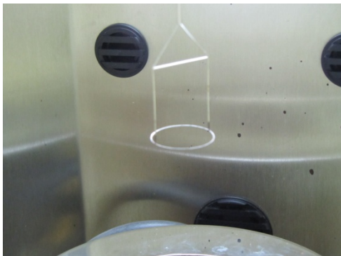
Slika 3: Merjenje površinske napetosti s tenziometrom, z metodo obročka (foto: M. Pavlič)
