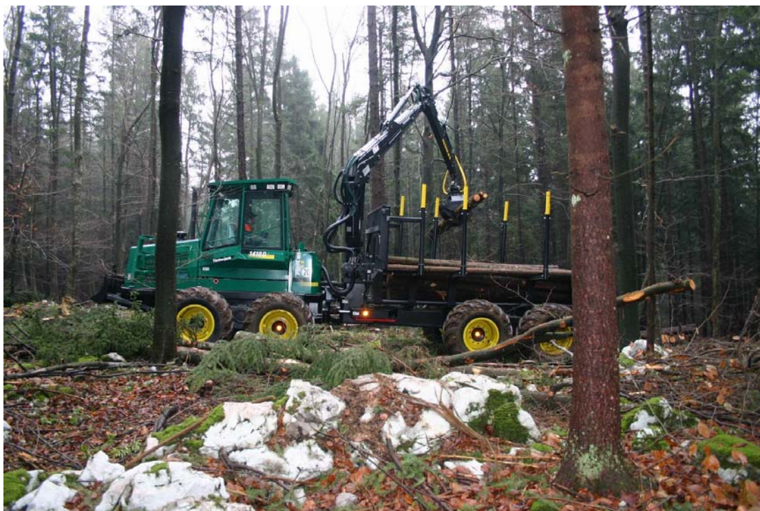
Slika 4: Zgibni polprikoličar – Timberjack 1410 D v revirju Škocjan-Unec (Foto: Arhiv GG Postojna)
