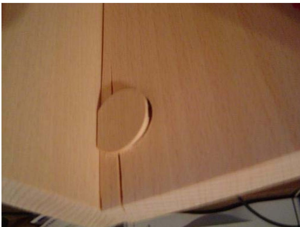
Slika 37: Prikaz napake lom po lesu
