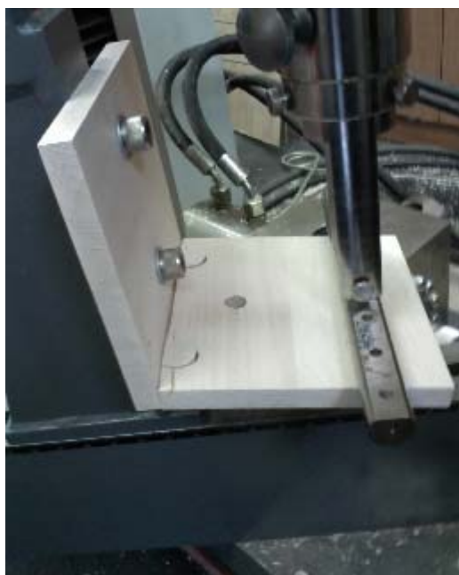
Slika 25: Izgled porušitve – masivni les z lesenim vijakom s prečno matico.
