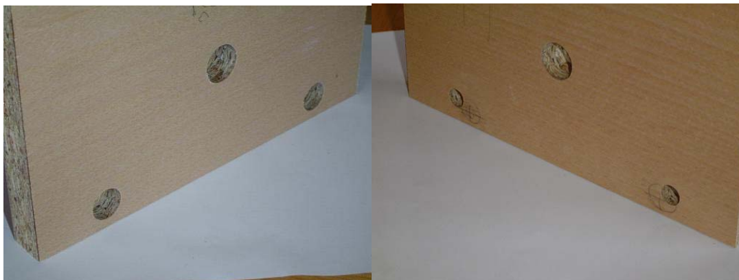
Slika 33: Pri izvrtini za vijak ni prišlo do poškodb
