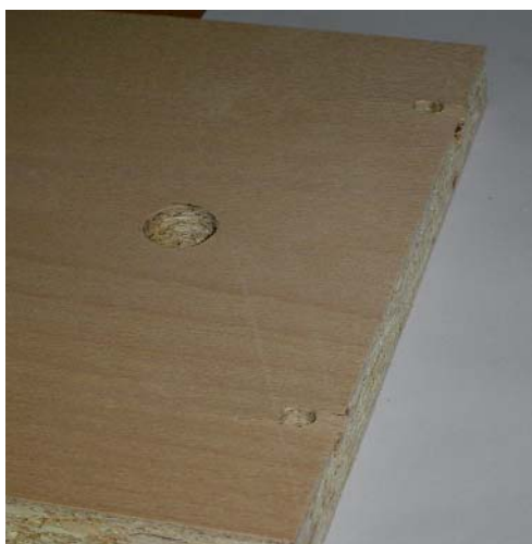
Slika 35: Napaka na iverni plošči pri prečni matici
