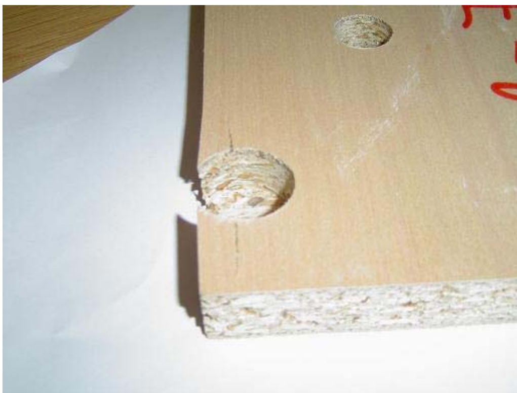
Slika 32: Poškodba izvrtine matice lesenega vijaka
