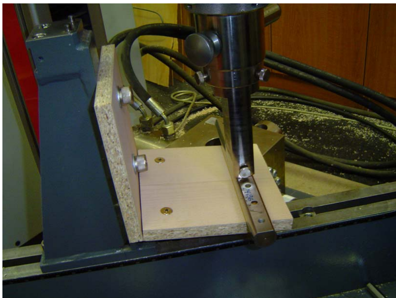
Slika 31: Izgled porušitve - izsrednik v iverni plošči
