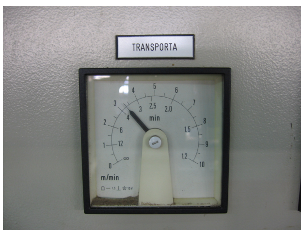
Slika 10: Prikazovalnik hitrosti pomika furnirja skozi sušilnico Babcock.
