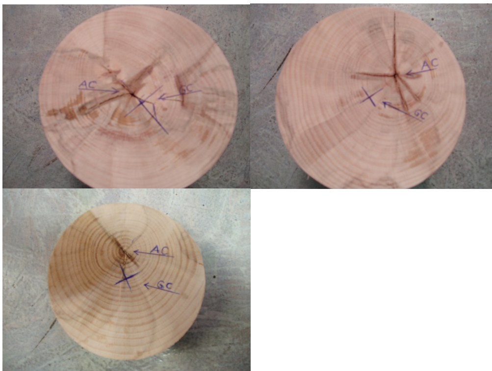
Slika 47: Prečni prerez okroglic od luščenja furnirja iz poskusnih hlovov z rdečim srcem
