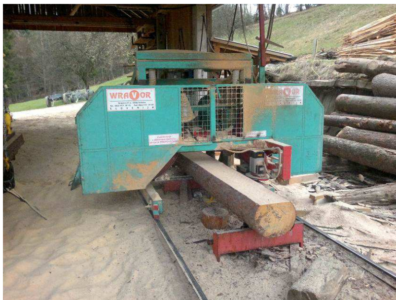
Slika 3: Žaganje smrekove hlodovine na tračnem žagalnem stroju (Foto: A. Žurbi)
