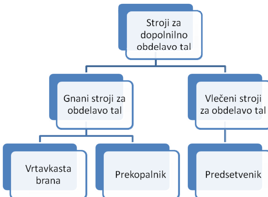
Slika 1: Razdelitev strojev za dopolnilno obdelavo tal (Bernik, 2005)
