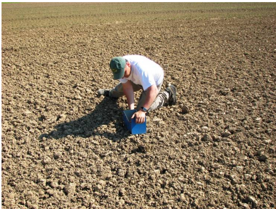
Slika 13: Odvzem vzorca s posebno lopato (foto: Peter Zver, 2009)
