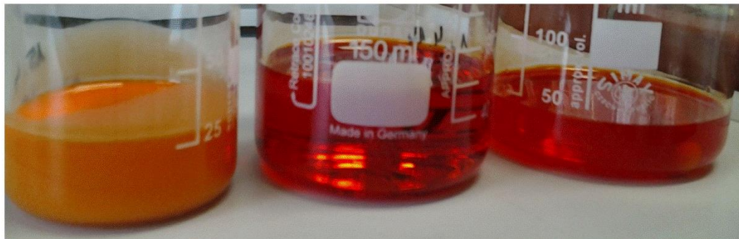
Slika 35: Emulzije v različnih korakih priprave alginatnih submikronskih delcev, obarvane z barvilom Sudan II. Od leve proti desni: emulzija alginata v olju, emulzija nanodelcev \text{CaCl}_2 v olju in emulzija alginatnih submikronskih delcev v olju.
