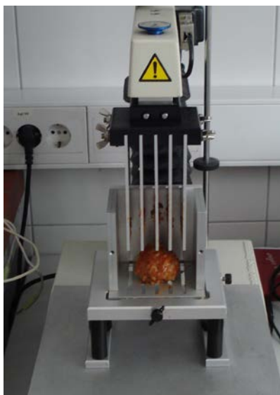
Slika 7: Aparat za merjenje teksture Texture Analyser TA.XT plus s Kramerjevo celico (Foto: Jana Anzeljc)
