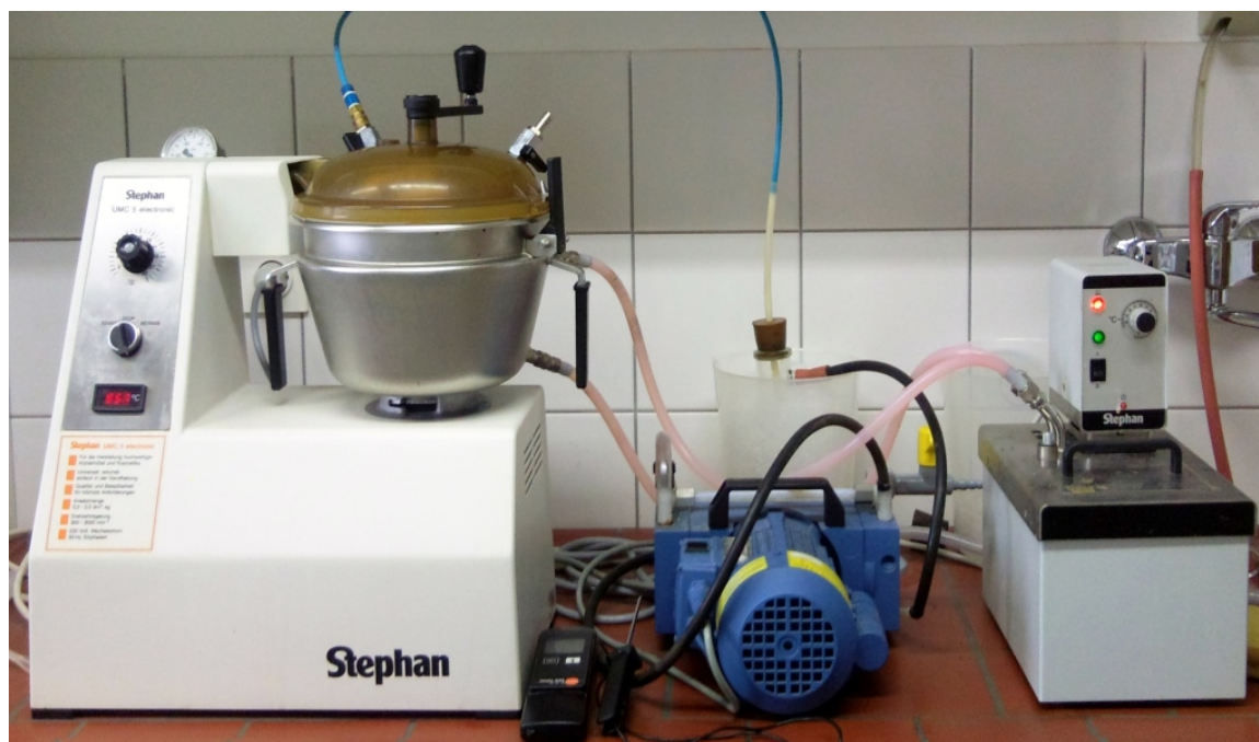
Slika 7: Naprave za pripravo jagodnega džema
