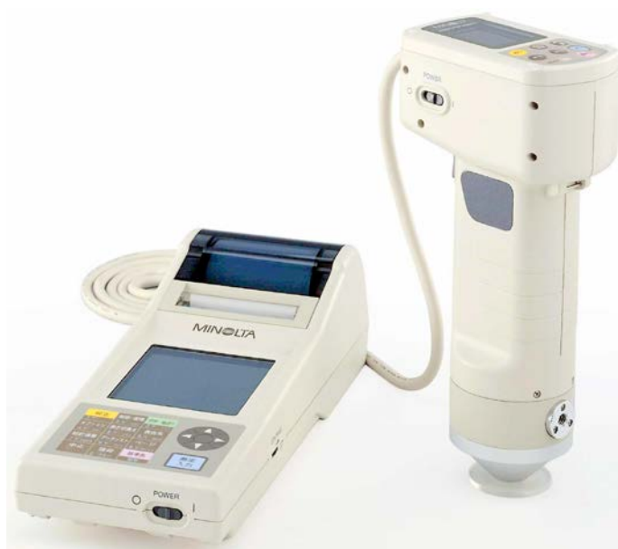
Slika 9: Kromameter Minolta CR 400/41
