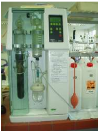
Slika 4: Destilacijska enota (Destillation Unit Büchi) za določanje beljakovin po Kjeldahlu
