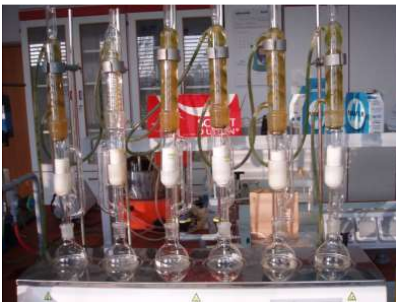
Slika 5: Aparatura za določanje maščob po Soxhletu
