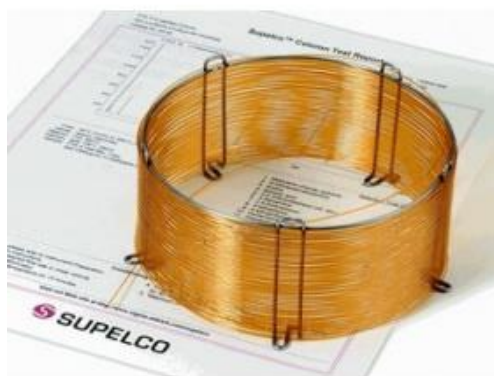
Slika 2: Kapilarna kolona Supelco_SPB PUFA (Sigma Aldrich, 2015)
