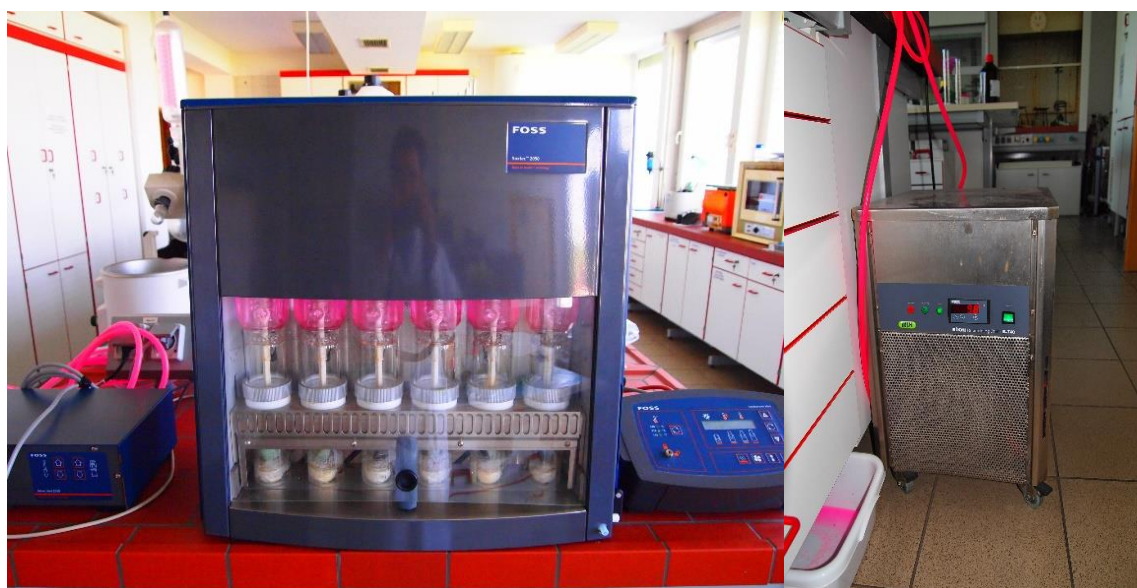
Slika 16: Aparatura za ekstrakcijo FOSS Soxtec™ 2050 (foto: Hari S.)
