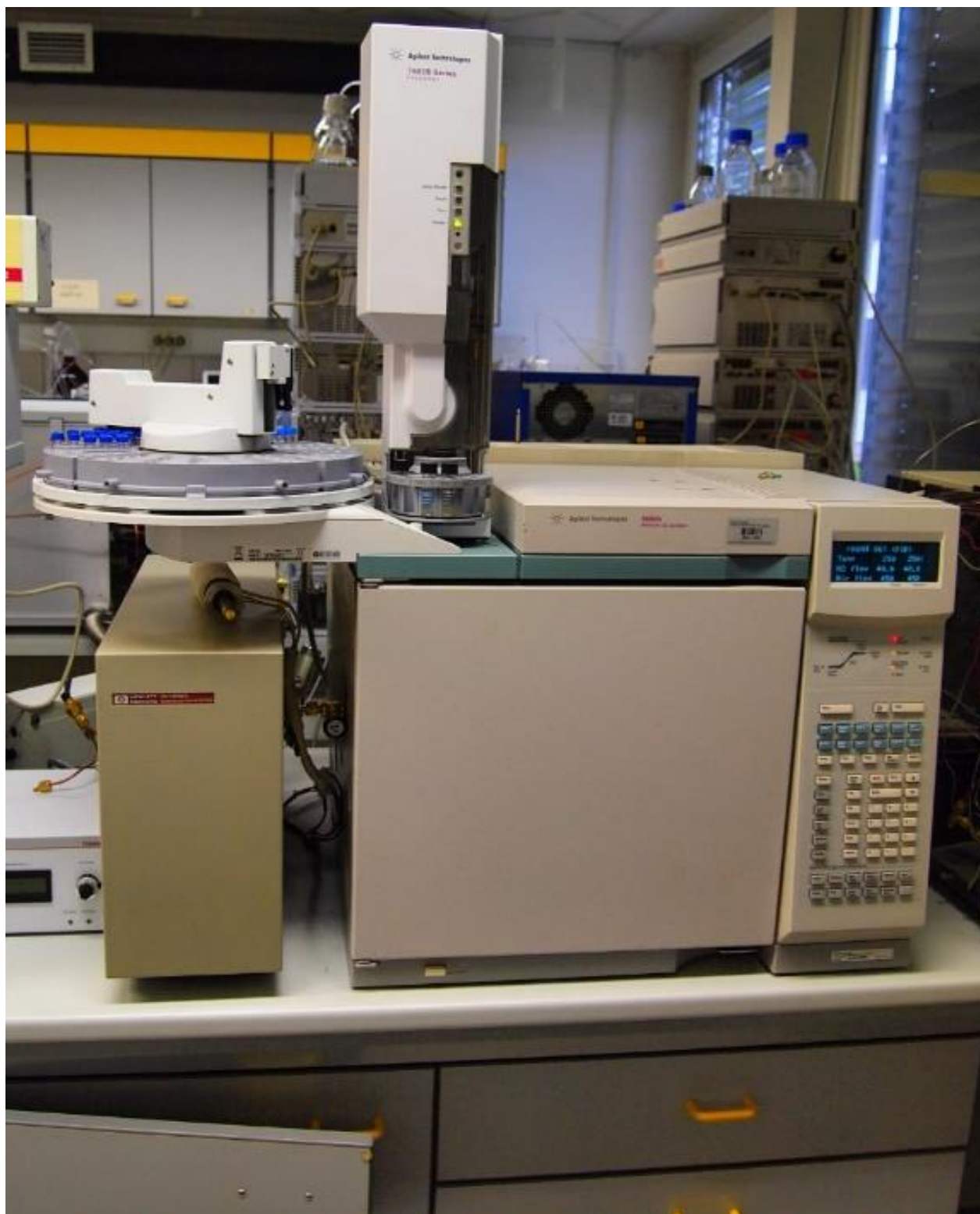
Slika 12: Plinski kromatograf Agilent Technologies 6890N (foto: Hari S.)
