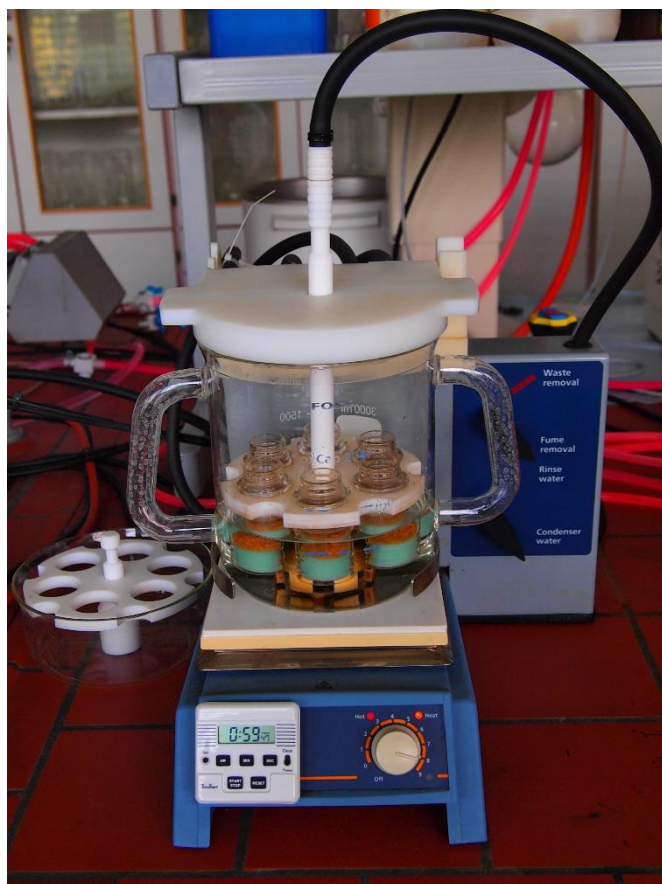
Slika 15: Aparatura za hidrolizo »FOSS SoxCap™ 2047« ( foto: Hari S.)
