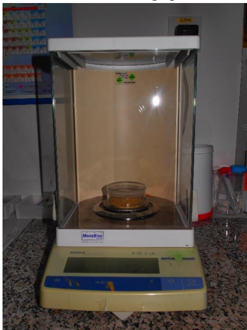
Slika 5: Tehtanje vzorca za določanje vsebnosti vode (foto: Hari S.)
