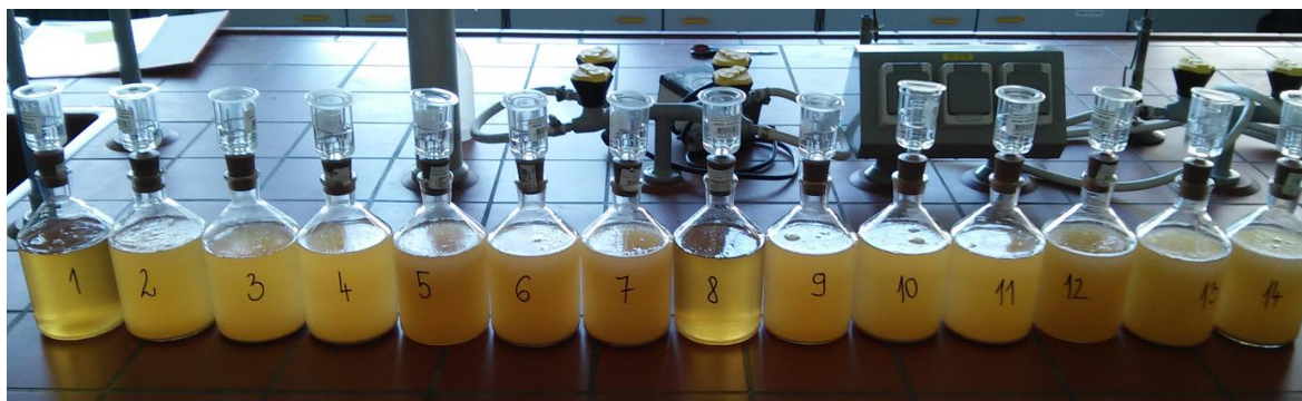
Slika 3: Fermentacijske steklenice takoj po inokulaciji
