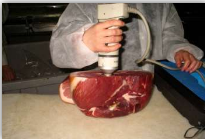
Slika 6: Meritve CIE L^* , a^* , b^* barvnih parametrov (foto: Šegula B.)
