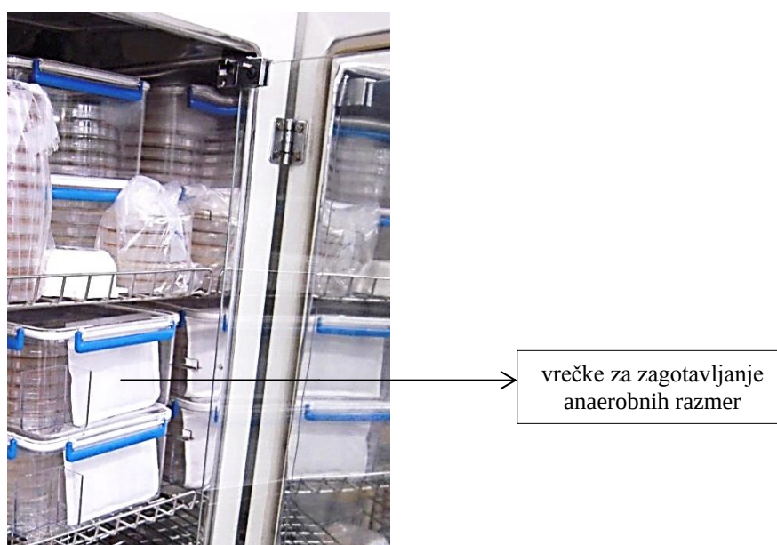
Slika 5: Notranjost inkubatorja in anaerobne razmere z uporabo GENbox-a ter vrečk za zagotavljanje anaerobnih razmer.
