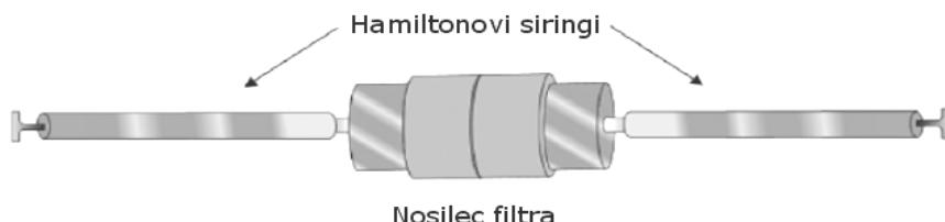
Slika 9: Ekstrudor, ki sestoji iz dveh siring in vmesne teflonske nosilne podpore kjer je polikarbonatna membrana (Mozafari in sod., 2008).
